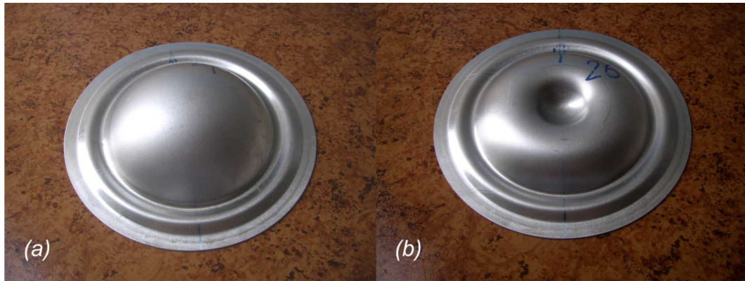
Slika 4.7: Oblikovane rondele; a. Klasično hidraulično udubljivanje b. Modificirano hidraulično udubljivanje
