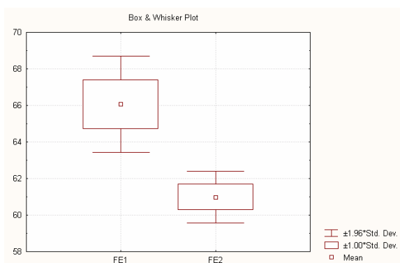
Slika 7.2.3: Dijagram raspona sile F_e za uzorke 106 i 1725
