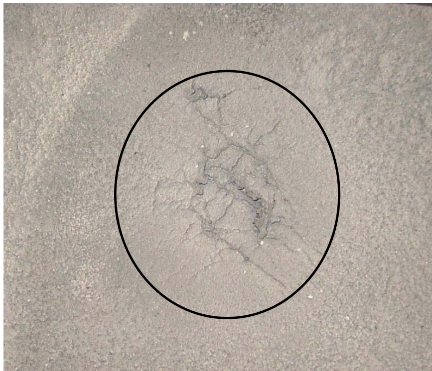
Slika 9.10. Ploča iz kalupa izrađenog iz pijeska granulacije G1.
