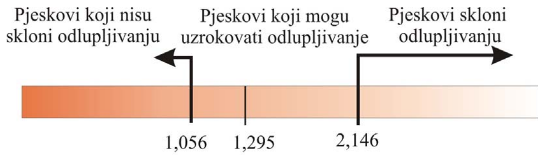
Slika 9.8 Shematski prikaz klasifikacija ljevačkih pjeskova s obzirom na sklonost odlupljivanju
