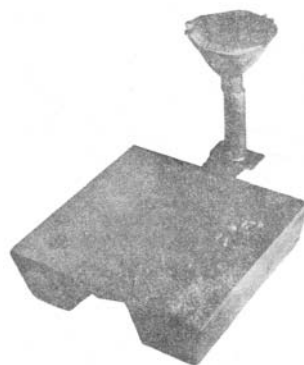
Slika 4.36 Test odljevak prema Kilshaw-u [29]
