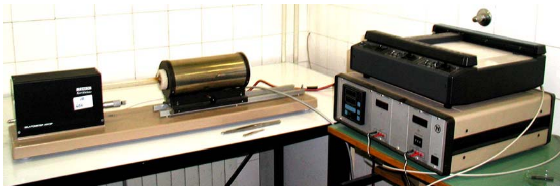
Slika 8.2 Izgled elektroničkog dilatometra Netzsch 402 EP
