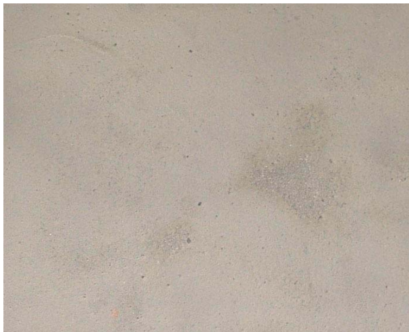
Slika 9.9. Ploča iz kalupa izrađenog iz pijeska granulacije G2.
