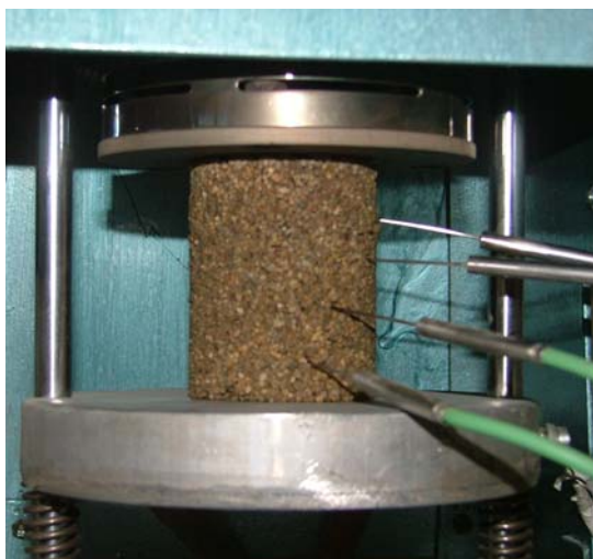
Slika 6.4 Mehaniizam za držanje uzorka
