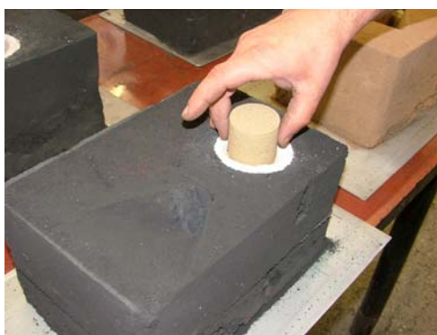
Slika 7.2 Umetanje uzorka u kalup
