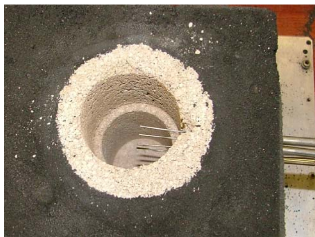
Slika 7.5 Unutrašnjost kalupa s mjernim osjetilima bez uzorka
