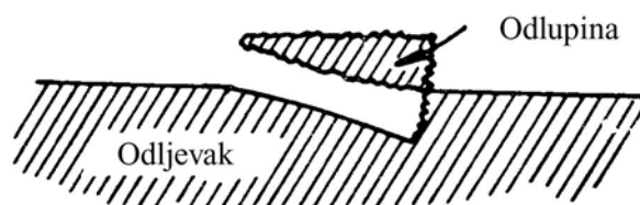
Slika 4.34 Tip odlupine koji nastaje kod Aachenskog testa [27,28]
