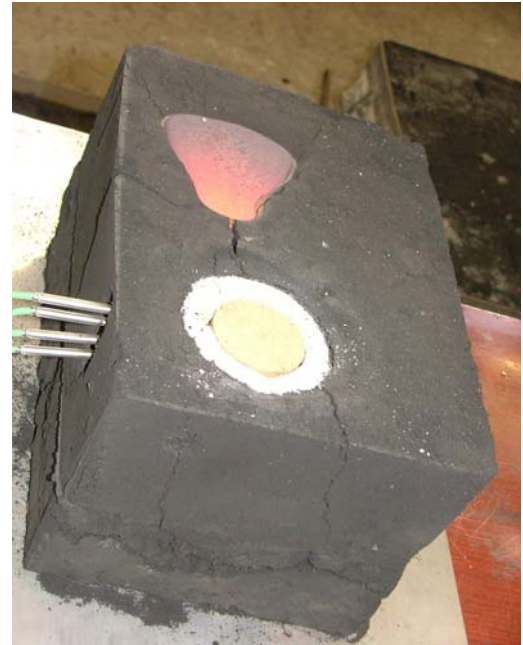
Slika 7.9. Sivi lijev prilikom mjerenja
