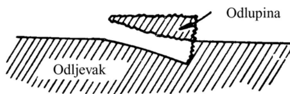
Slika 4.34 Tip odlupine koji nastaje kod Aachenskog testa [27,28]
