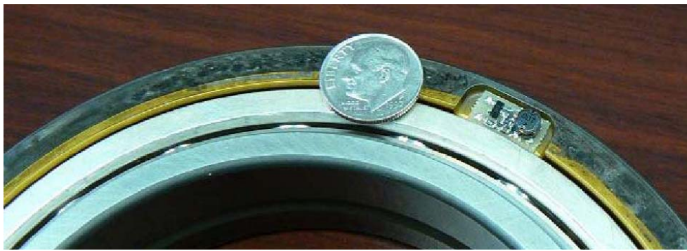
Slika 7.9 Bežični sklop s osjetilom u kotrljajnom kugličnom ležaju [141]
