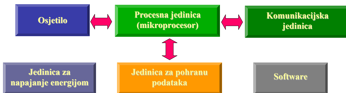
Slika 7.1 Komponente sklopa s osjetilom
