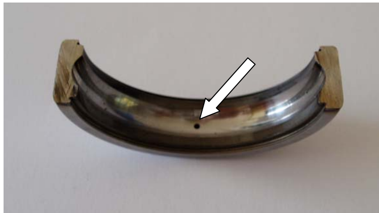
Slika 5.11 Fotografija oštećenja na vanjskom prstenu kotrljajnog kugličnog ležaja SKF 6206
