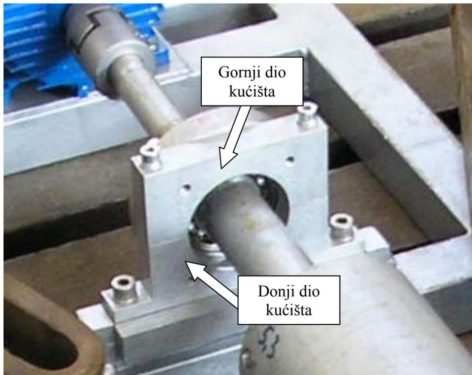
**Slika 5.3** Gornji i donji dio kućišta ispitivanog kotrljajnog kugličnog ležaja SKF 6206
