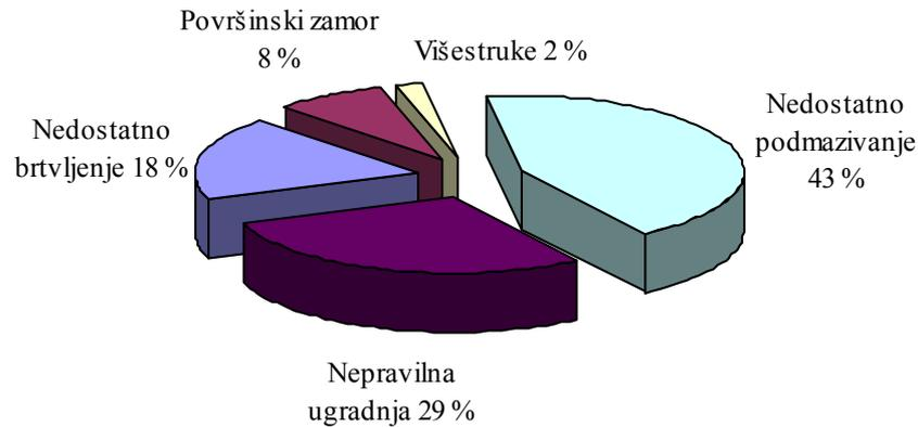
**Slika 4.3** Uzroci oštećenja u kotrljajnom kugličnom ležaju [109]
