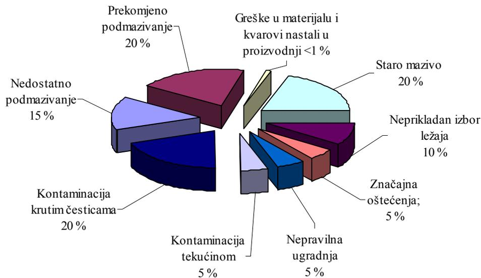
**Slika 4.4** Uzroci kvarova u kotrljajnim ležajevima [110]
