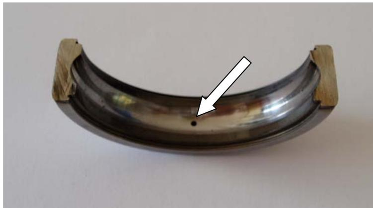
**Slika 5.11** Fotografija oštećenja na vanjskom prstenu kotrljajnog kugličnog ležaja SKF 6206
