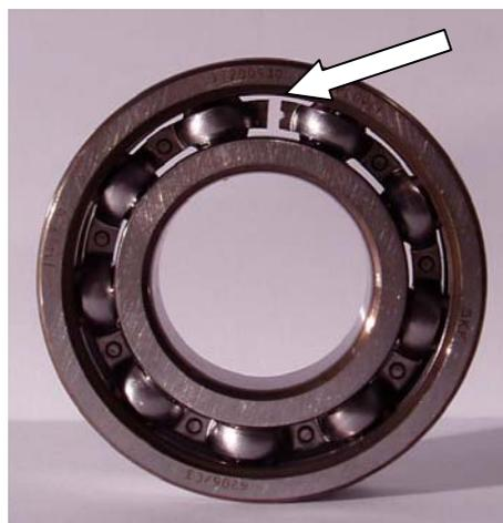
**Slika 5.15** Fotografija oštećenja kaveza kotrljajnog kugličnog ležaja SKF 6206
