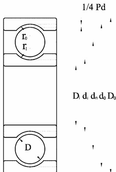
**Slika 4.2** Glavne mjere u kotrljajnom kugličnom ležaju
