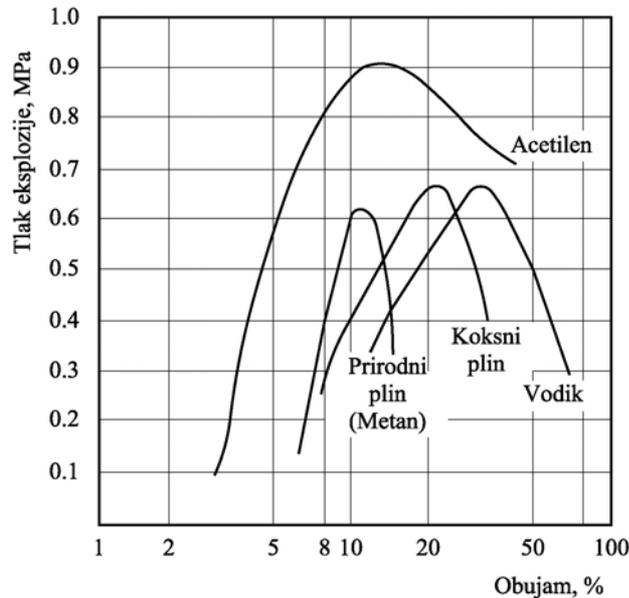
**Slika 2.4** Tlak eksplozije u ovisnosti o obujamnoj koncentraciji za nekoliko plinova. Temeljna pretpostavka za paljenje eksplozivne smjese jest ta da je temperatura uzročnika paljenja dovoljno iznad temperature paljenja plina, kao i da posjeduje energiju iznad najmanje energije potrebne za paljenje eksplozivne smjese.
