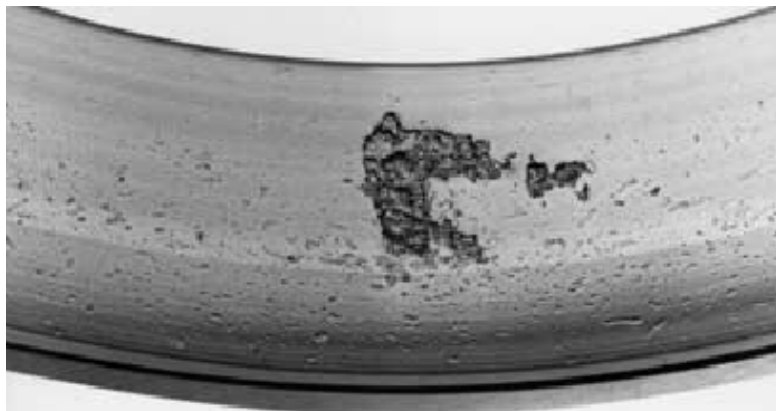
Slika 4.8 Točkasto oštećenje nastalo zamorom na vanjskoj kotrljajnoj stazi kotrljajnog koničnog ležaja [110]
