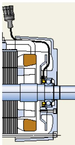
**Slika 7.4** Presjek ležajnog sklopa elektromotora s prikazom ugradnje temperaturnog osjetila koji posjeduje žičanu vezu i priključak („konektor”) [137]
