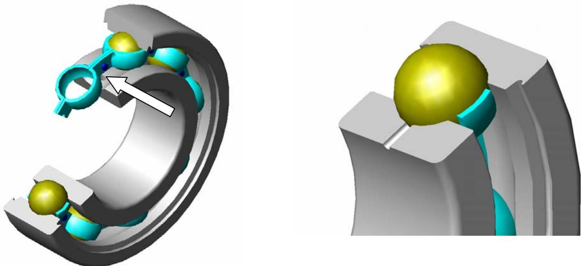
**Slika 5.12** Izgled oštećenja na unutarnjem prstenu kotrljajnog kugličnog ležaja SKF 6206
