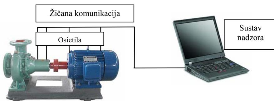
**Slika 7.2** Shematski prikaz nadzora temperature kotrljajnih kugličnih ležajeva pomoću žičane veze koja povezuje sklop s osjetilom u opremi i sustav nadzora
