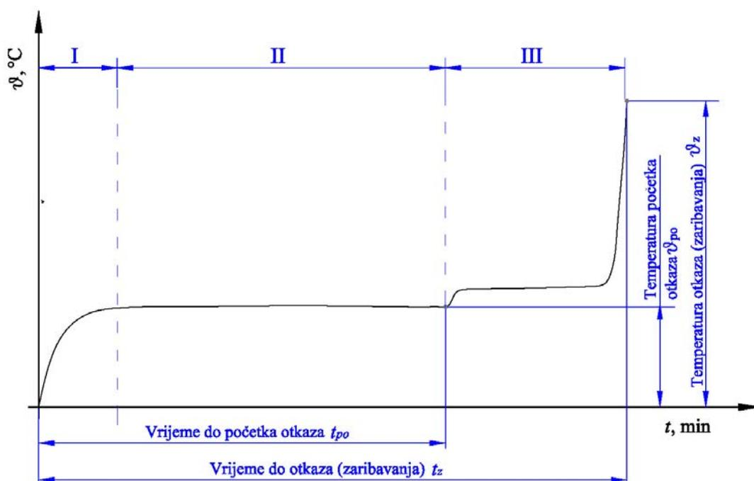
**Slika 6.1** Tipični izgled temperaturne krivulje rada kotrljajnog kugličnog ležaja SFK 6206 s oštećenjem od trenutka kretanja u rad do trenutka otkaza (zaribavanja)
