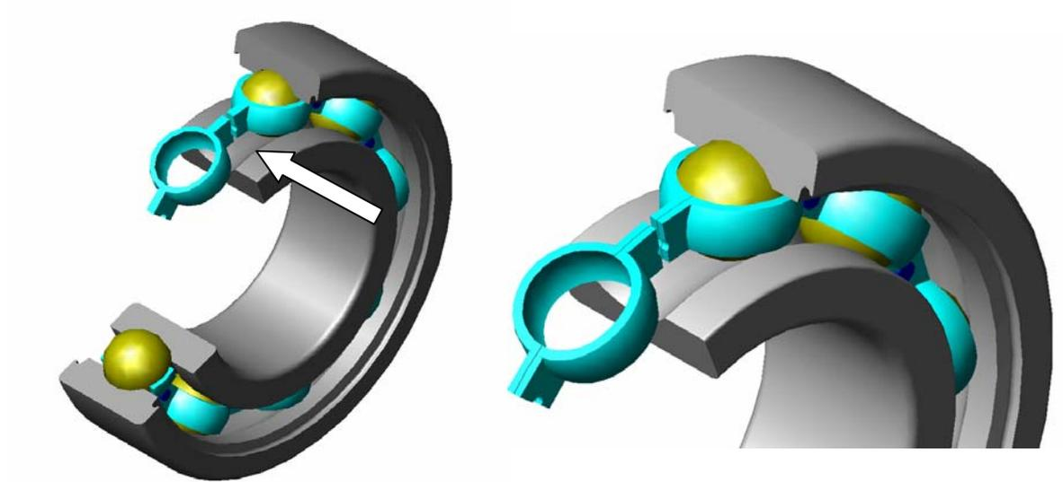
**Slika 5.14** Izgled oštećenja kaveza kotrljajnog kugličnog ležaja SKF 6206
