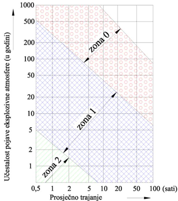
**Slika 2.15** Vremenski kriterij za podjelu ugroženog prostora na zone opasnosti u omjeru na učestalost pojave i trajanja eksplozivne atmosfere i uzročnika paljenja
