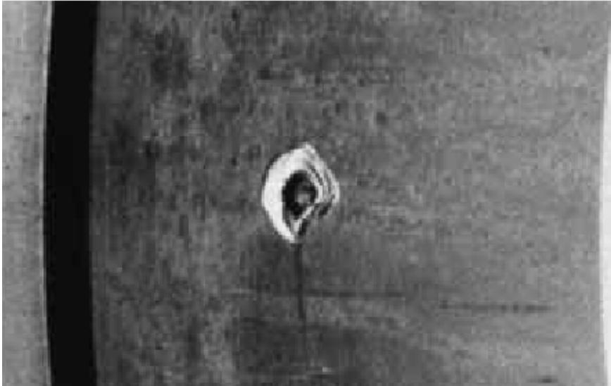
**Slika 4.11** Točkasto oštećenje ležaja nastalo prolaskom električne struje [112]
