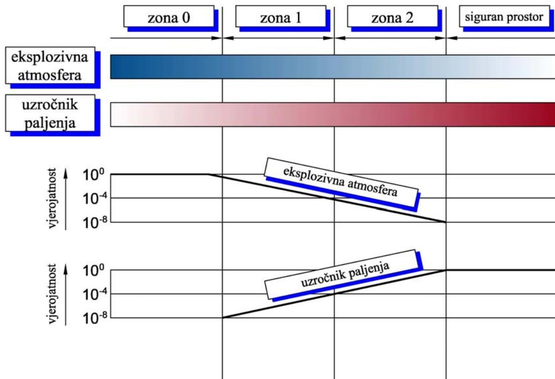
Slika 2.14 Vjerojatnosti postojanja eksplozivne atmosfere i uzročnika paljenja u pojedinim zonama opasnosti
