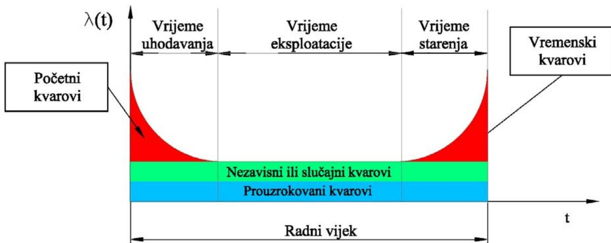
**Slika 4.6** Prikaz vjerojatnosti nastanka kvara u radnom vijeku kotrljajnog kugličnog ležaja
