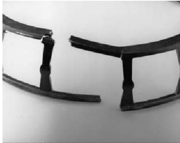
**Slika 4.9** Razoran prijelom kaveza kotrljajnog ležaja [110]
