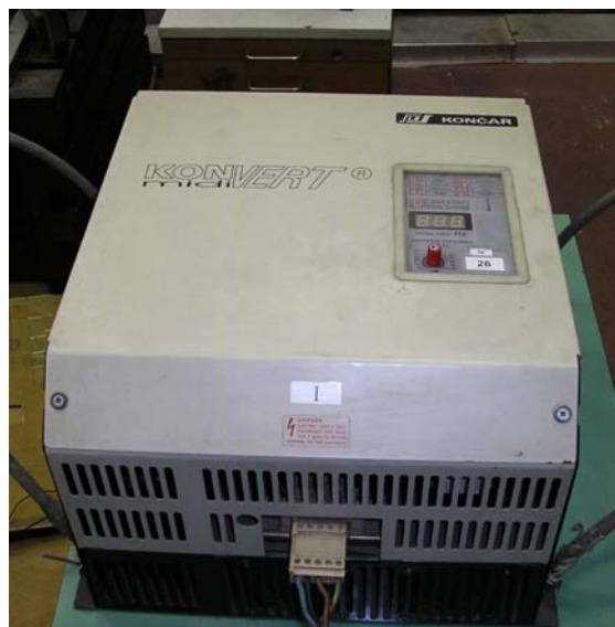
Slika 5.6 Frekvencijski pretvarač Končar tip: konvert midi
