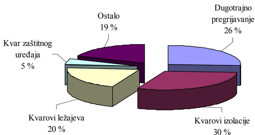
**Slika 3.4** Struktura učestalosti kvarova elektromotora u industrijskim postrojenjima [100]
