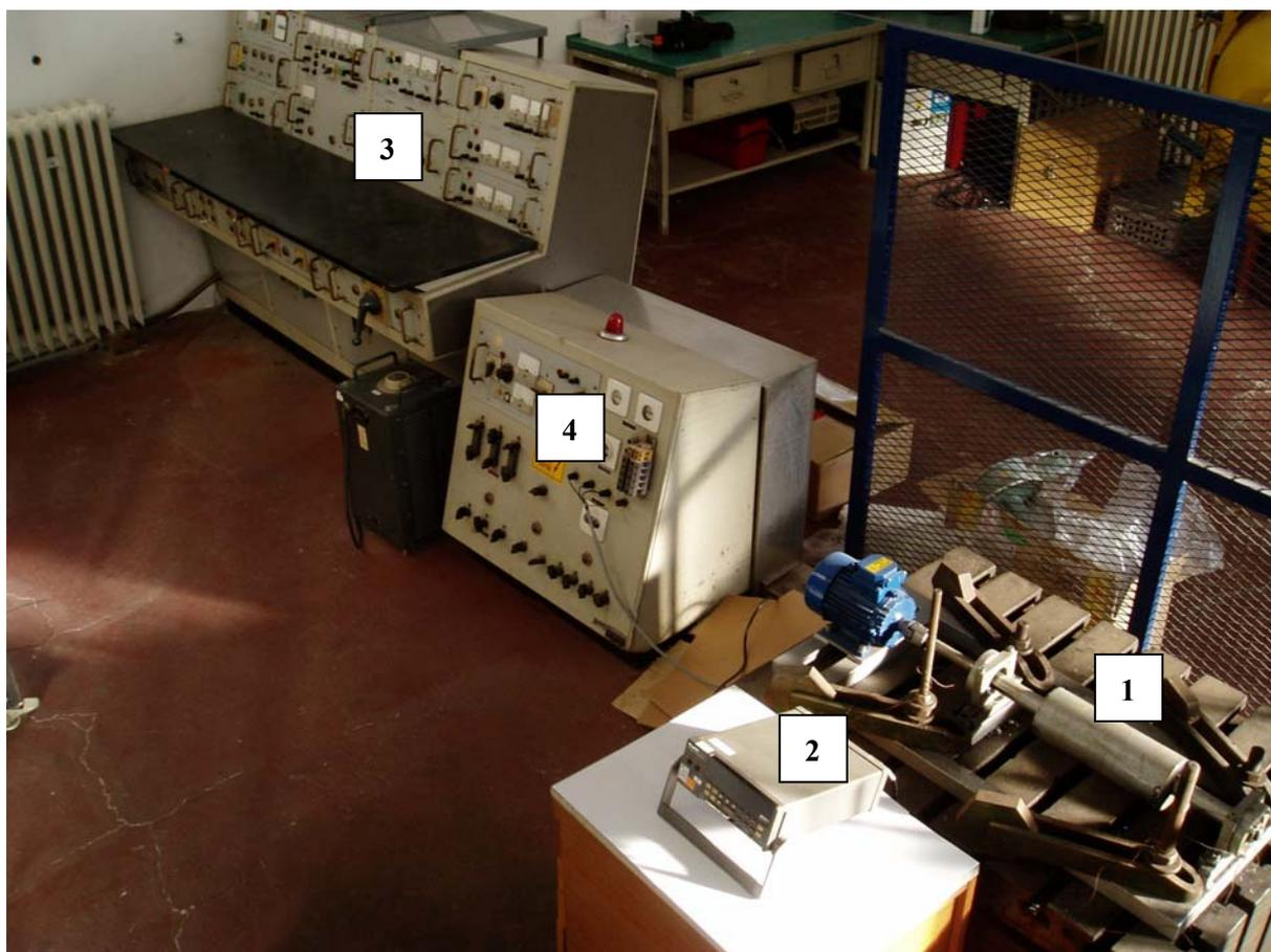
**Slika 5.2** Prikaz radnog mjesta za provođenje ispitivanja kotrljajnih kugličnih ležajeva: 1 – ispitni sustav, 2 – uređaj za pohranjivanje podataka temperature „Hydra-Fluke”, 3 – upravljački stol, 4 – napajanje električnom energijom
