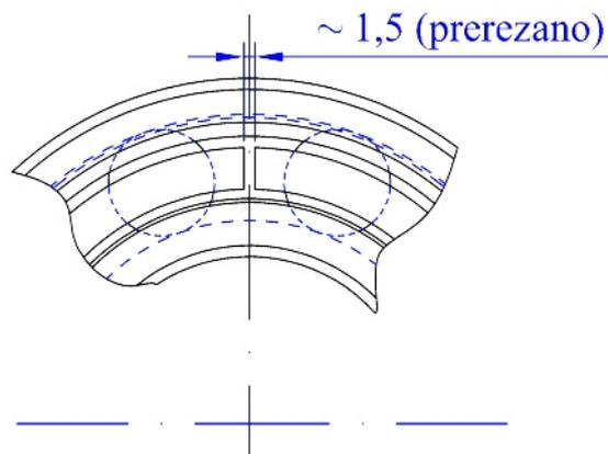
**Slika 5.9** Dimenzije oštećenja kaveza kotrljajnog kugličnog ležaja SKF 6206
