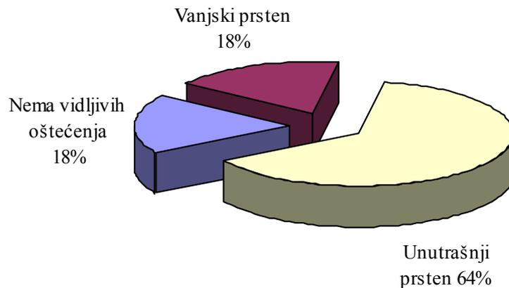
**Slika 4.5** Učestalost kvarova na unutaršnjoj i vanjskoj kotrljajnoj stazi kod kugličnih ležajeva [111]
