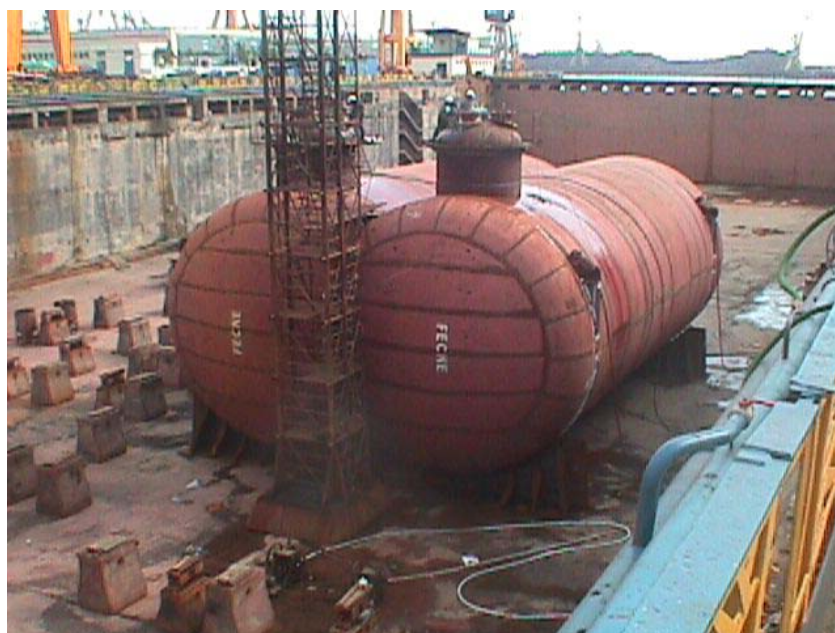
Slika B-5 Jedan od dvodijelnih spremnika u brodogradilištu
