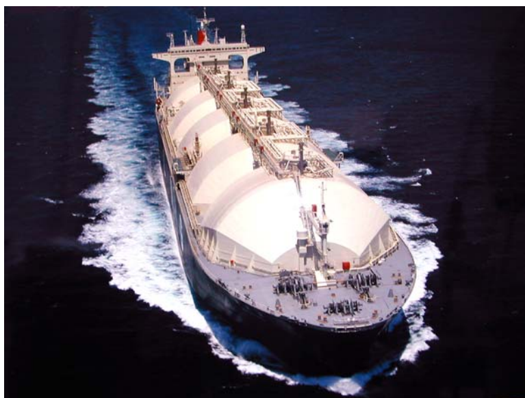
Slika 2-3 LNG brod, 145000 m 3 , Moss-Type spremnici
