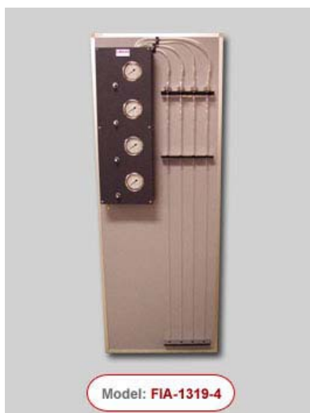
Slika 88. Aparatura za mjerenje količine olefina
