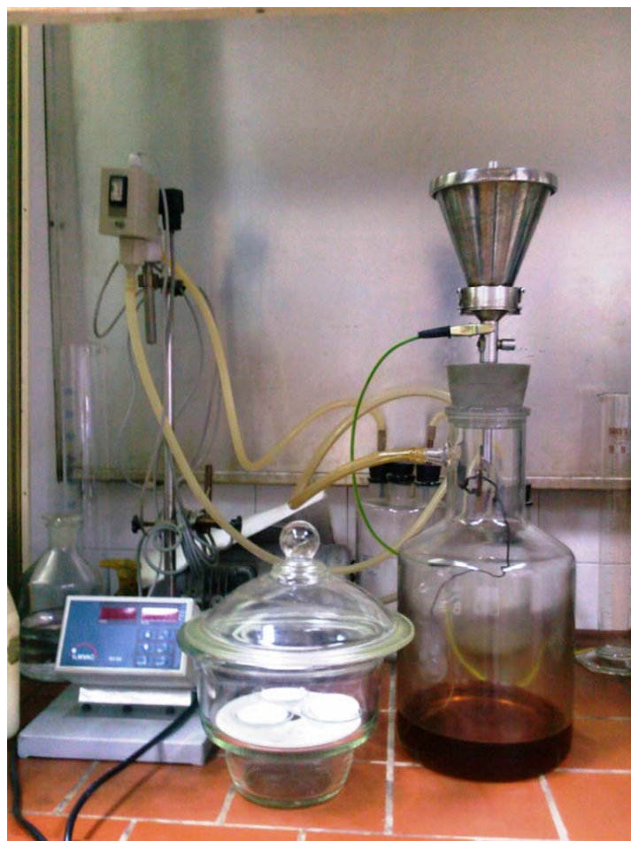
Slika 44. Aparatura za mjerenje količine sedimenta
