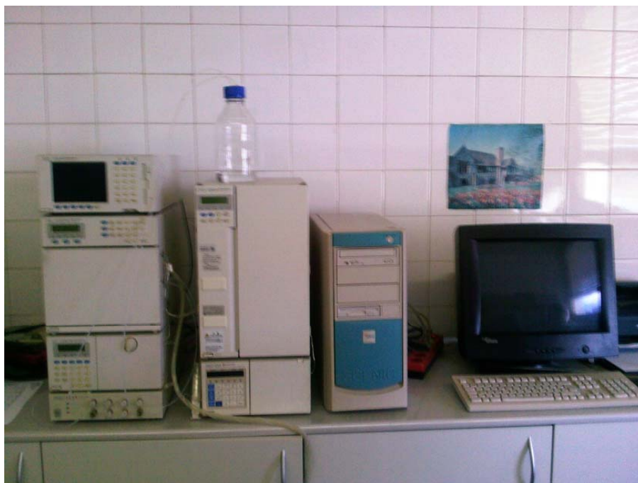
Slika 56. Aparatura za mjerenje količine policikličkih aromatskih ugljikovodika
