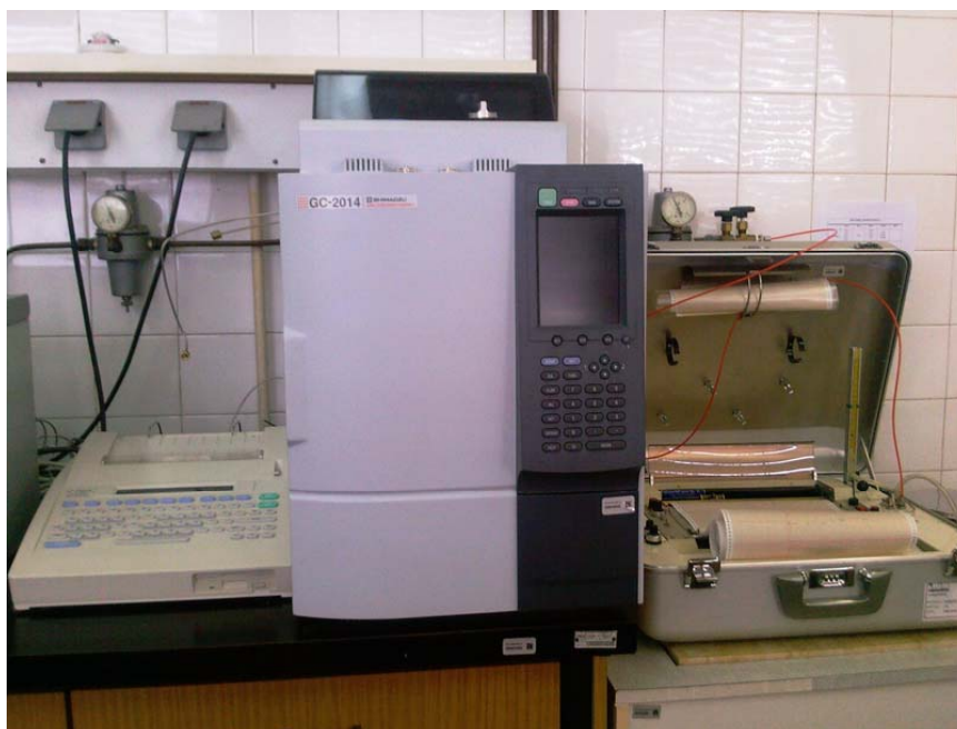
Slika 85. Aparatura za mjerenje količine benzena
