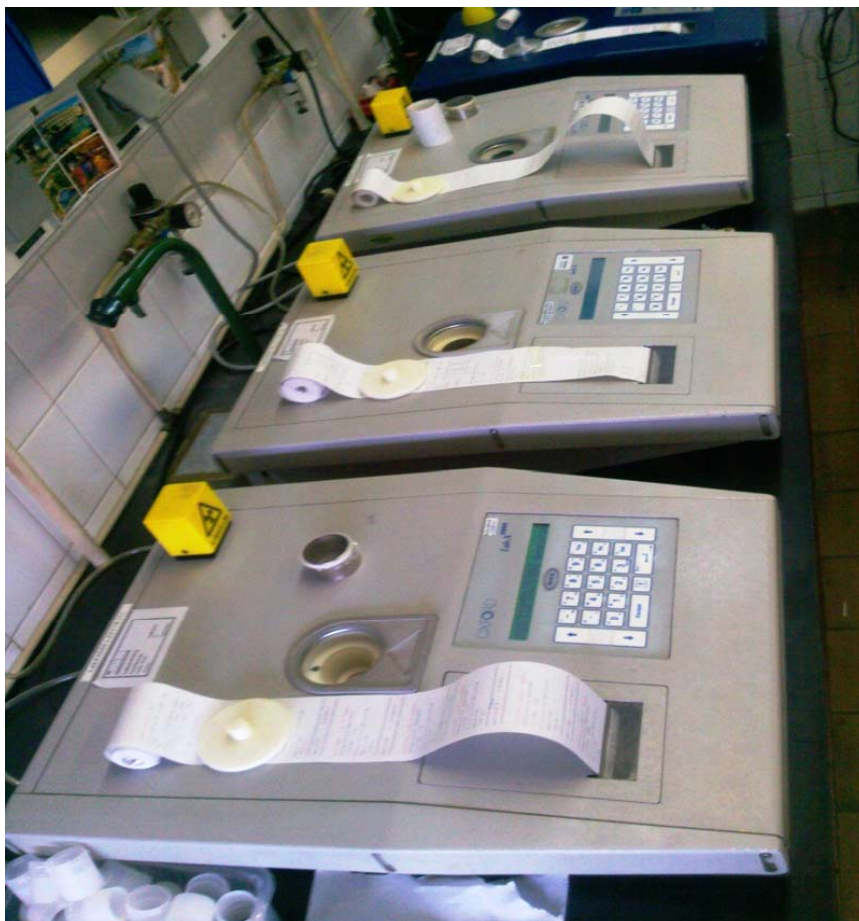
Slika 33. Aparatura za mjerenje ukupne količine sumpora
