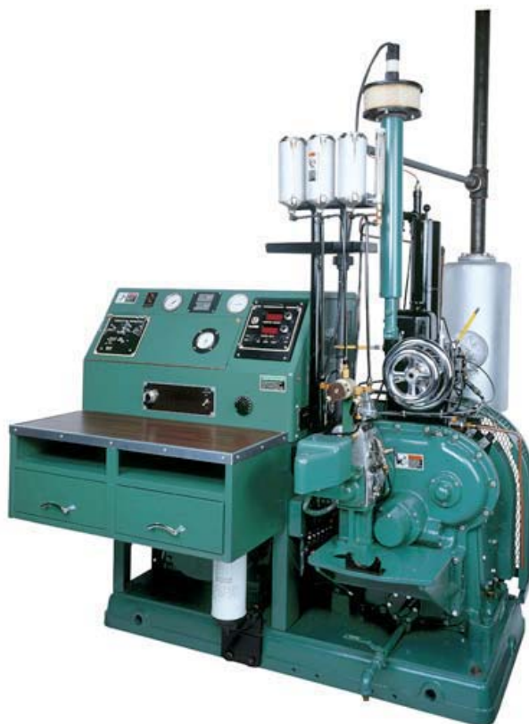
Slika 67. Aparatura za mjerenje cetanskog broja
