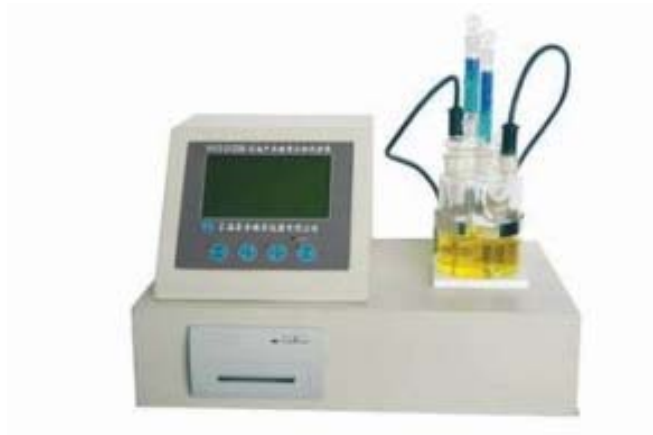
Slika 22. Aparatura za mjerenje količine vode
