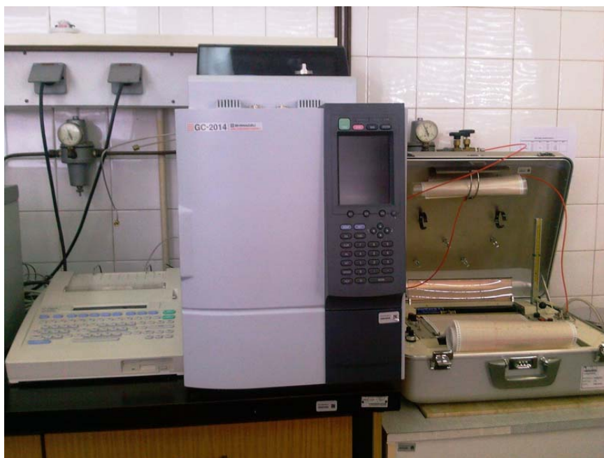
Slika 85. Aparatura za mjerenje količine benzena
