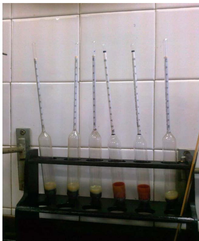
Slika 11. Areometri za mjerenje gustoće
