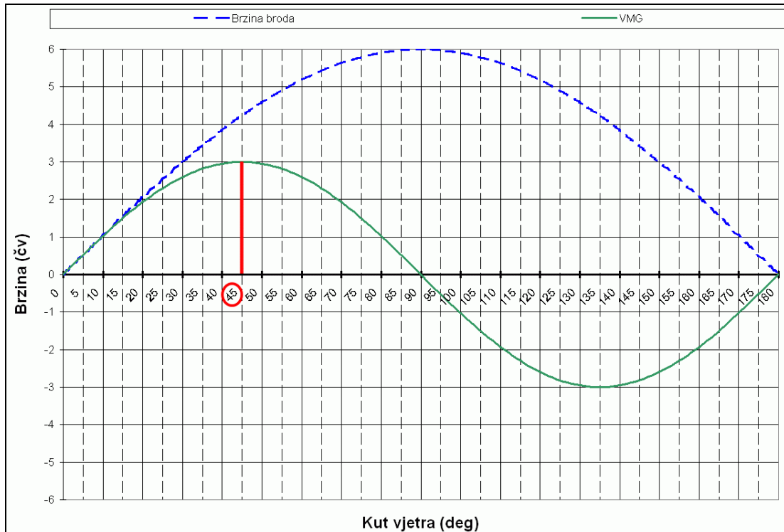
Slika 5-7: Prikaz brzine broda i VMG brzine za različite kutove vjetra
