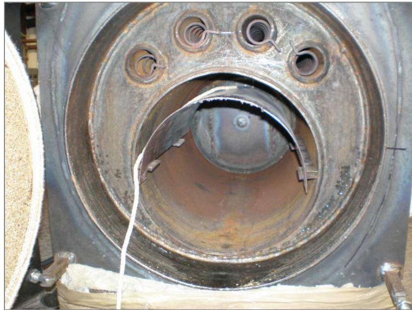
Slika 6.26 Kondenzacija dimnih plinova kod četvrtog prototipa NTK25
