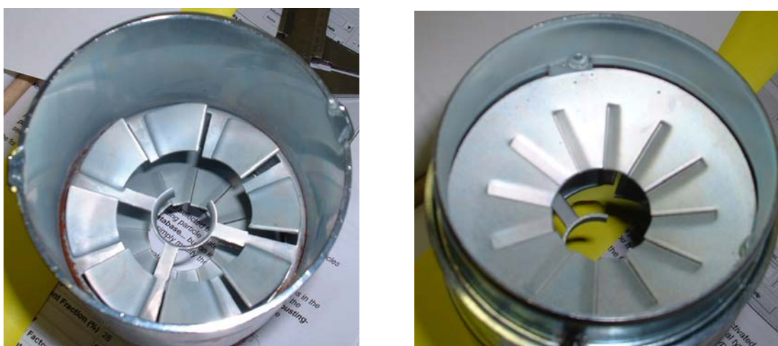
Slika 2.24 Pogled na vrtložnik i zastoju ploču uljnog plamenika Bentone B10
