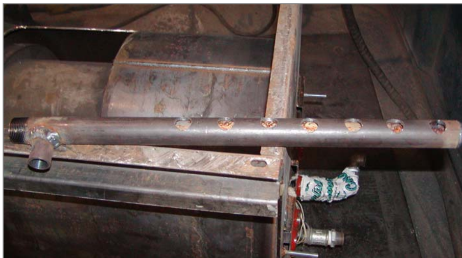
Slika 6.25 Povratni vod kod četvrtog prototipa NTK25
