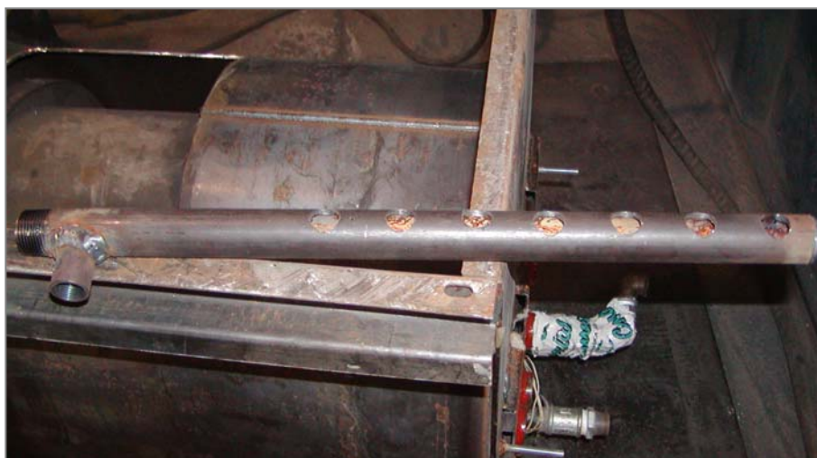
Slika 6.25 Povratni vod kod četvrtog prototipa NTK25
