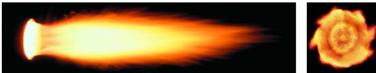
Slika 3.1 Plamen iz uljnog plamenika firme Weishaupt
