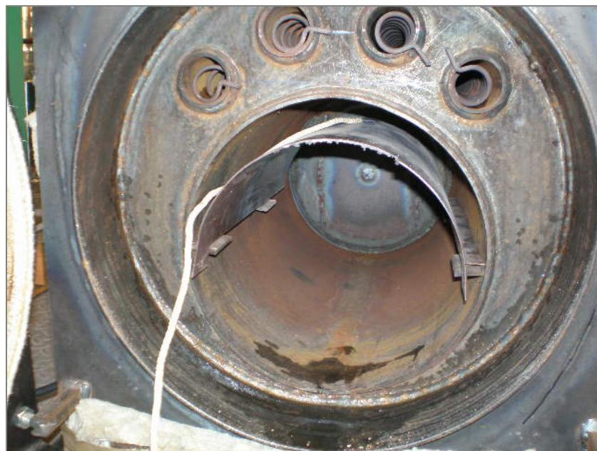
Slika 6.21 Kondenzacija dimnih plinova na trećoj izvedbi prototipa NTK25
