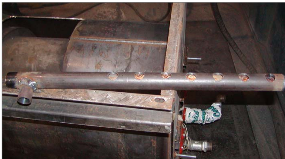
Slika 6.25 Povratni vod kod četvrtog prototipa NTK25
