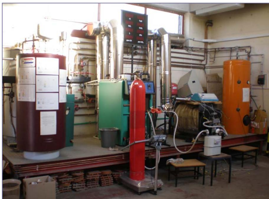
*Slika 5.2 Ispitna linija za ispitivanje kotlova u Laboratoriju za toplinu i toplinske uređaje*
