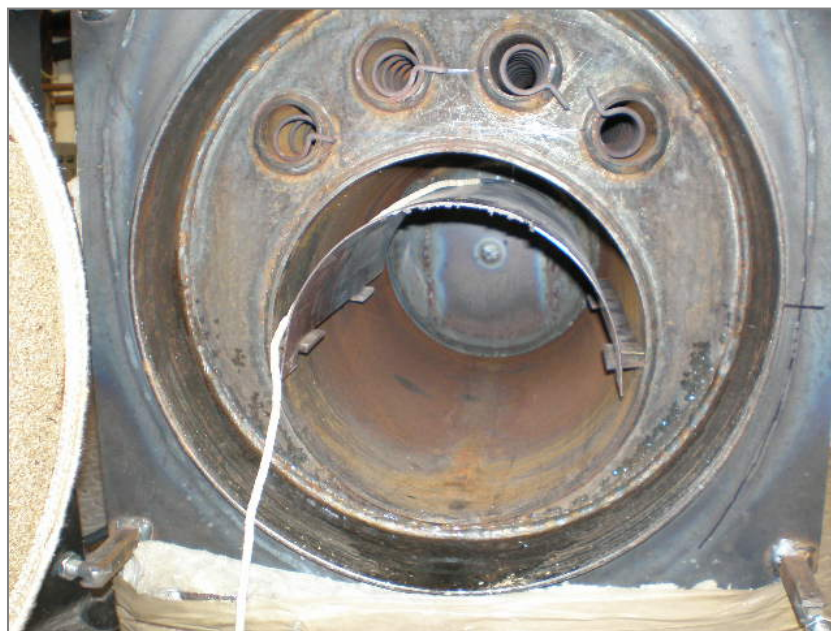
Slika 6.26 Kondenzacija dimnih plinova kod četvrtog prototipa NTK25
