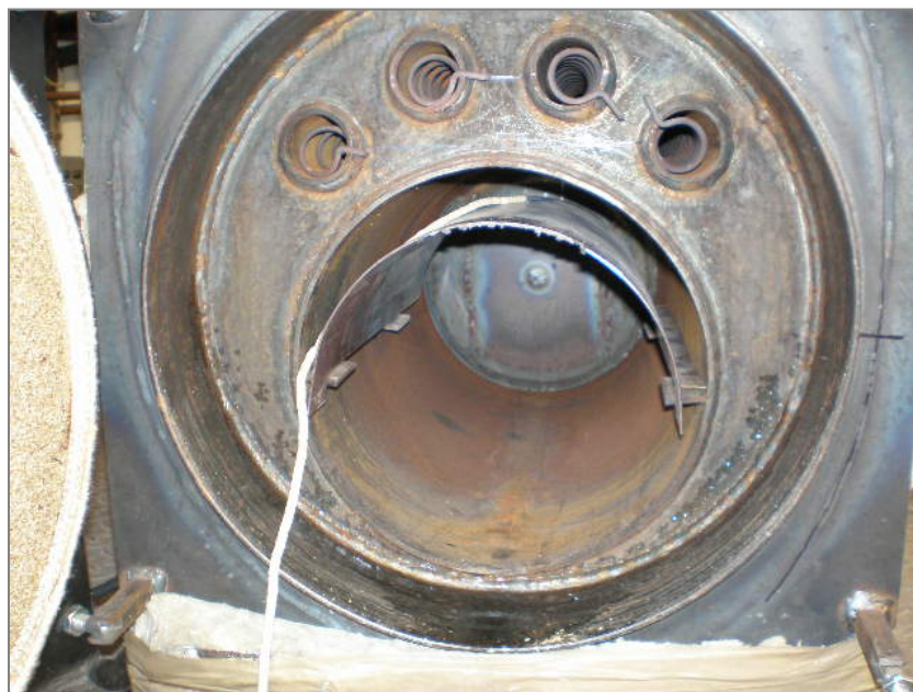
Slika 6.26 Kondenzacija dimnih plinova kod četvrtog prototipa NTK25
