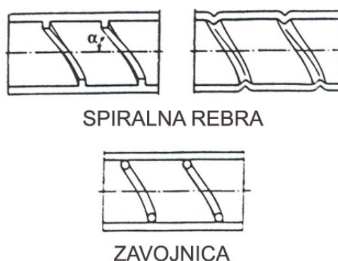
Slika 3.6 Hrapavost na unutrašnjoj stijenci cijevi
