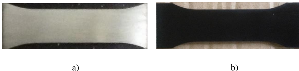
Slika 6-3. Ispitni uzorci za ispitivanje a) bez premaza i b) s nanesenim crnim mat premazom.
