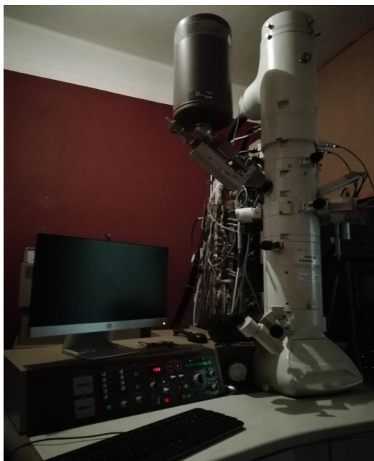
Slika 6-14. Transmisijski elektronski mikroskop JEOL JEM-2000-FX.
