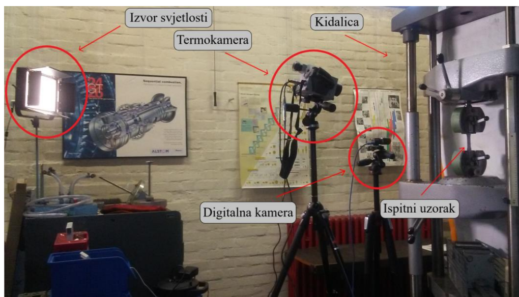
Slika 6-8. Raspored korištene opreme tijekom ispitivanja.
