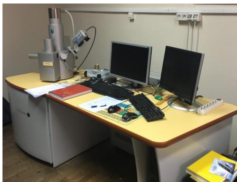
Slika 6-11. Pretražni elektronski mikroskop Tescan VEGA 5136 MM.
