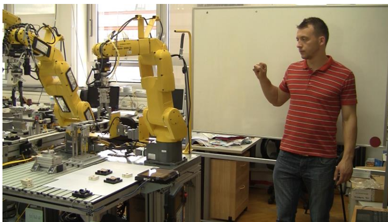
Slika 2-2. Upravljanje robotom teleoperacijom [51].
