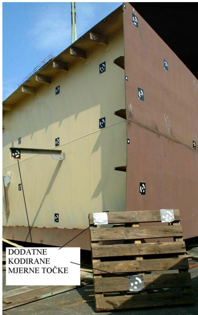
Slika 46: Postavljanje dodatnih mjernih točaka
