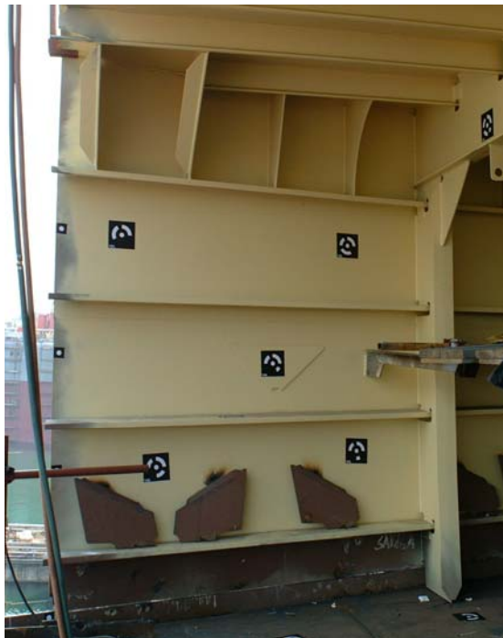
Slika 104: Mjerne točke na sekcijama svjetlog otvora
