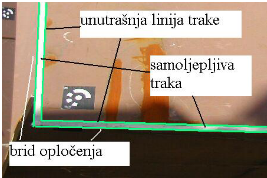
Slika 63: Postupak prepoznavanja samoljepljive trake u programskom paketu
