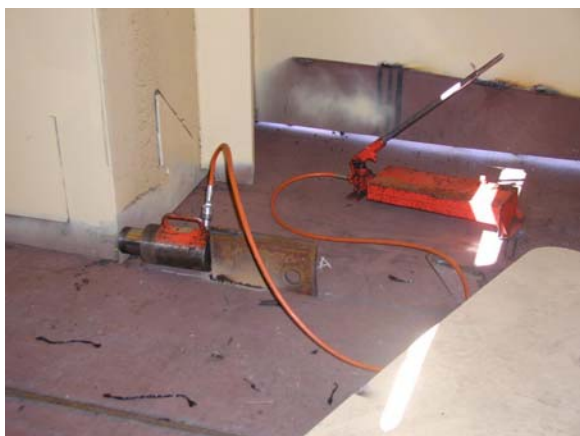
Slika 24: Hidraulička pumpa za pozicioniranje sekcije
