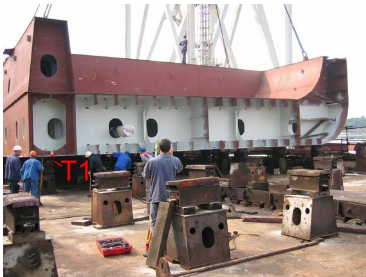
Slika 26: Kontrola centriranja sekcije
