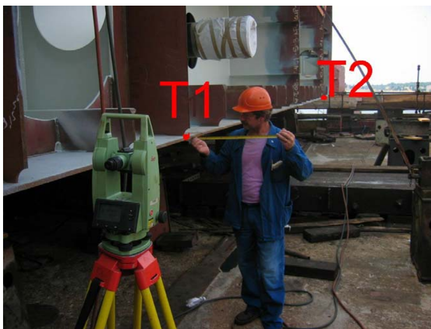
Slika 28: Kontrola okomitosti poprečnog presjeka broda
