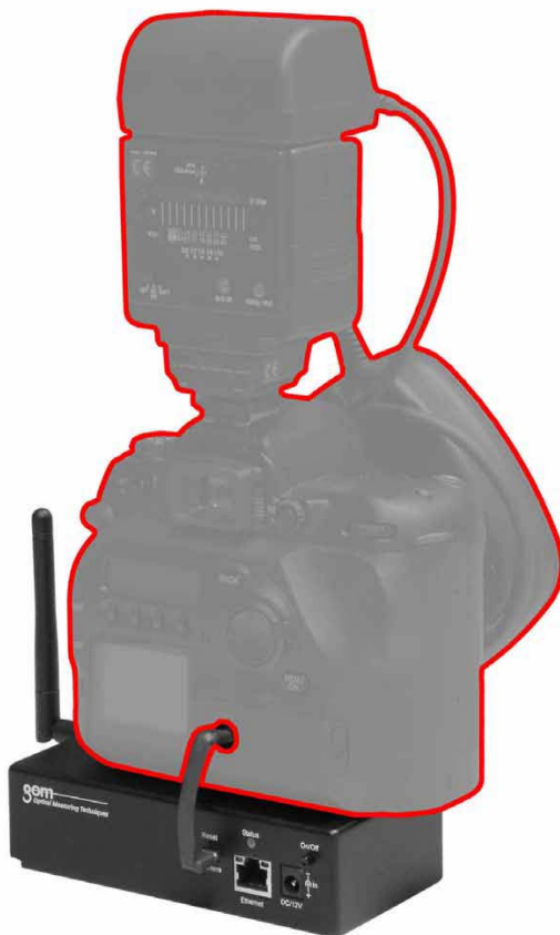
Slika 53: Uređaj za bežični prijenos snimljenih fotografija
