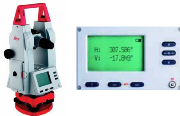
Slika 5: Mjerni dio uređaja i ekran elektroničkog teodolita
