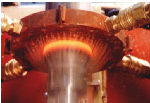
Slika 2.4 Rotaciono-posmično indukcijsko kaljenje osovine uz gašenje prskanjem
