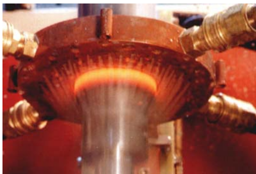
Slika 2.4 Rotaciono-posmično indukcijsko kaljenje osovine uz gašenje prskanjem
