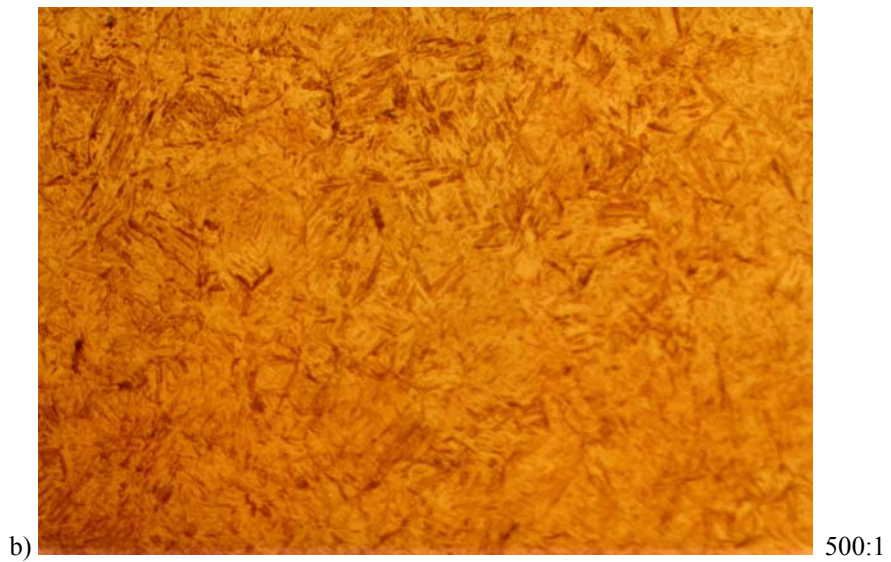
Slika 9.13 Mikrostruktura indukcijski zakaljenog ispitnog valjaka od čelika 42CrMo4 uz snagu generatora 30 kW ( f = 415 kHz) i posmičnu brzinu 4mm/s.
