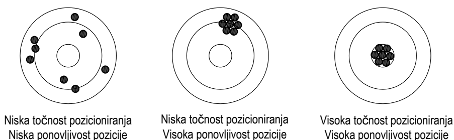
Slika 5.8 Točnost pozicioniranja i ponovljivosti pozicije pogona
