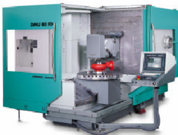
Slika 3.4 Kombinacija CNC glodaćeg i tokarskog alatnog stroja /9/
