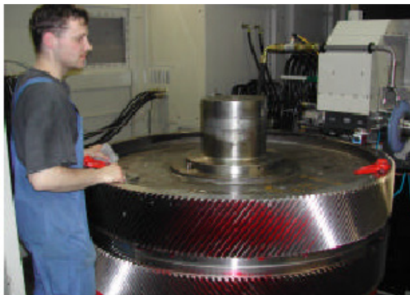
Slika 3.2 Obrada zupčanika sa strelastim zubima mase do 5000 kg na stroju s direktno pogonjenim okretnim stolom /7/
