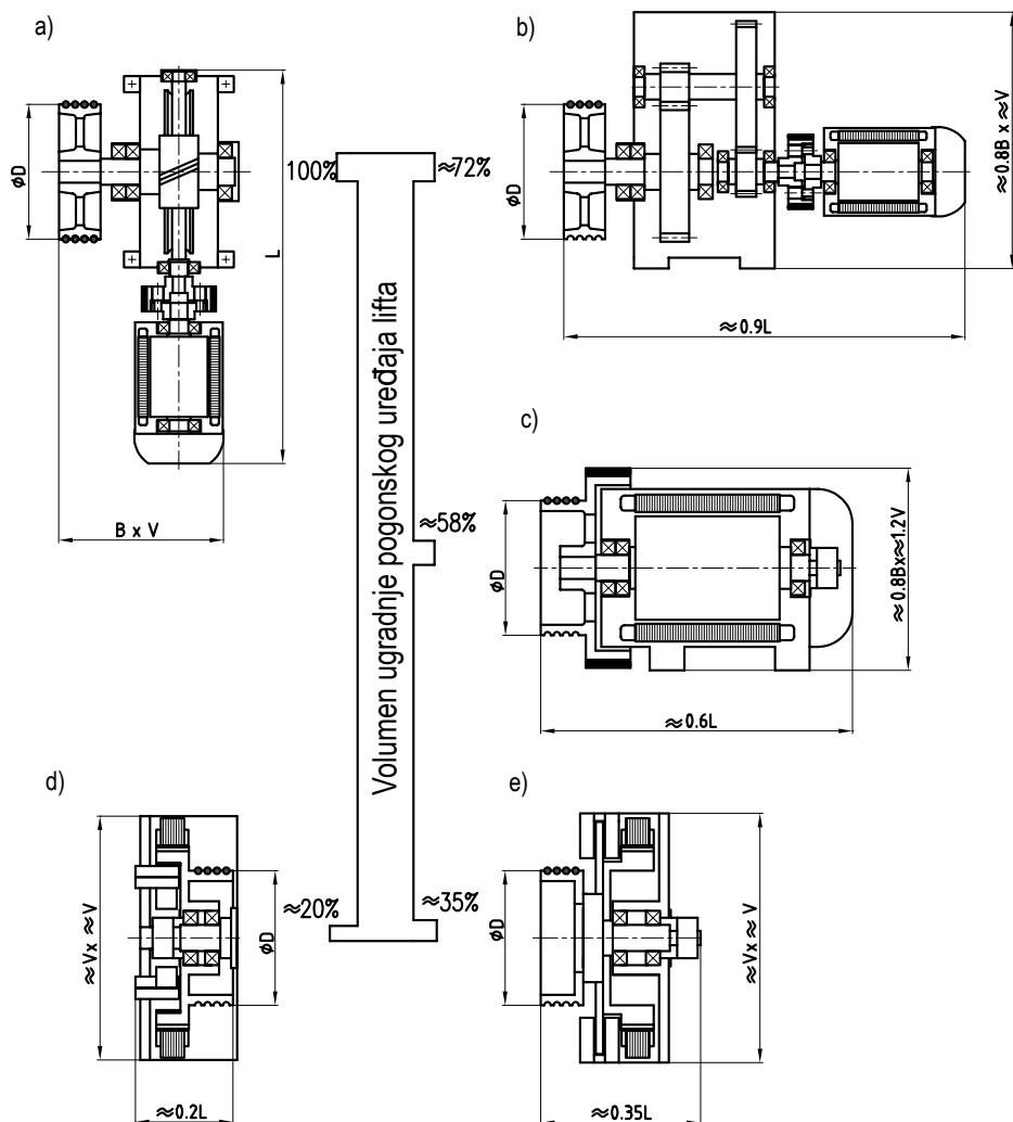
Slika 6.1 Strukture pogonskih mehanizama liftova
