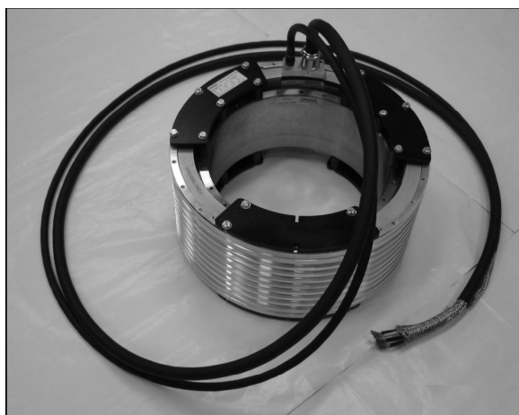
Slika 7.1 Fotografija motora 1FW6130-0PA10 („kit“ izvedba)
