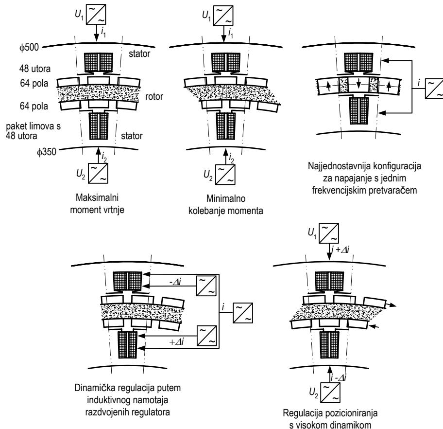
Slika 2.20 Varijacije povezivanja napajanja sa statorskim namotima za dupli stator u dalnjem razvoju PPSM-a
