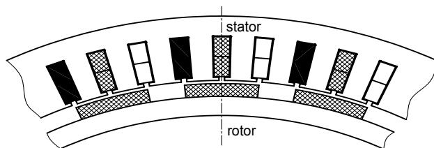
Slika 2.3 Princip izvedbe sinkronog motora s uzbudom putem trajnih magneta
