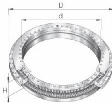
Slika 5.5 Aksijalno-radijalni valjkasti ležaj tip: YRT /20/
