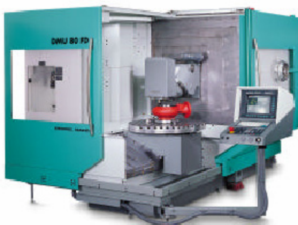
Slika 3.4 Kombinacija CNC glodačeg i tokarskog alatnog stroja /9/
