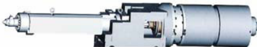
Slika 3.5 Pogon sklopa brizgaljke s dva visokomomentna motora, koji rade odvojeno kao pogon za plastifikaciju i pogon za brizganje /10/
