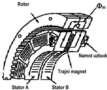
Slika 2.10 Princip izvedbe hibridnog motora s obostrano izraženim polovima i uzbudom putem trajnih magneta u statoru
