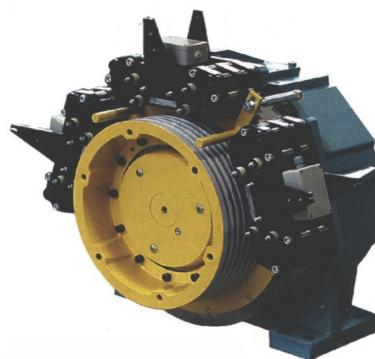
Slika 3.1 Pogonski mehanizam lifta s vanjskim disk kočnicama
