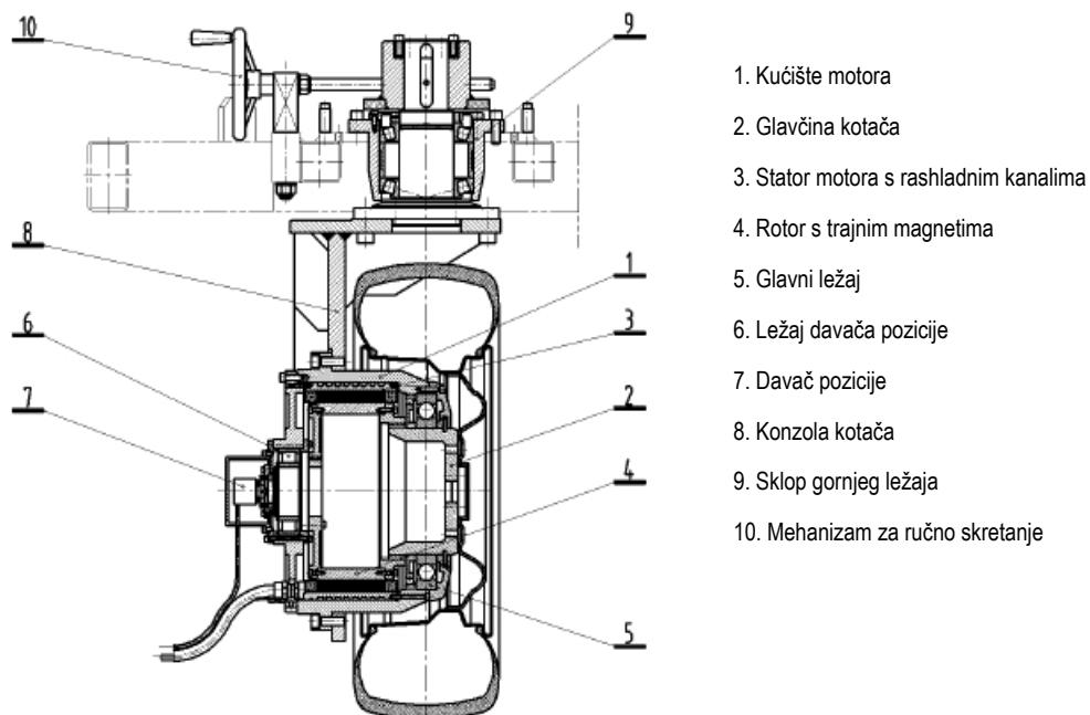
Slika 3.9 Sklop pogonskog kotača eksperimentalnog vozila
