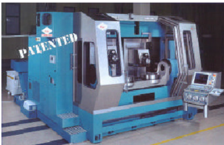
Slika 3.3 Obradni centar sa okretno–nagibnim stolom pogonjenog visokomomentnim motorima /8/
