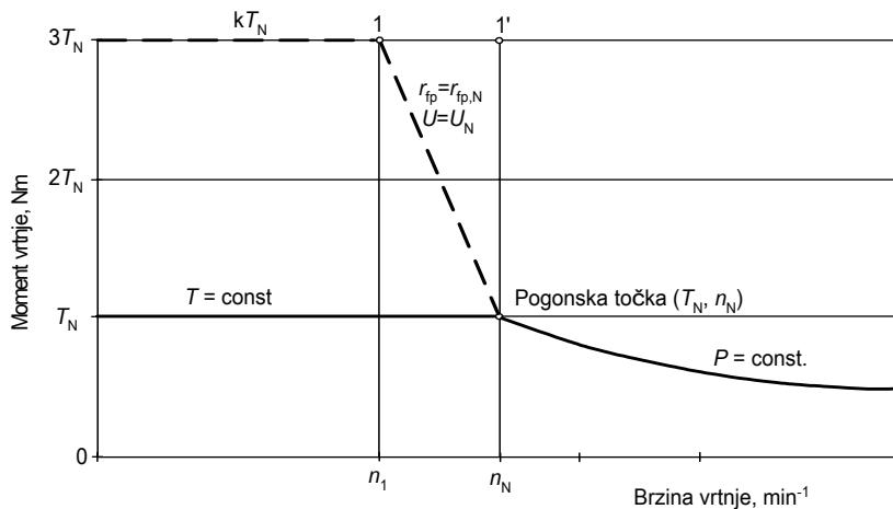
Slika 2.12 Definicija radnih točaka pogonskog stroja i frekvencijskog pretvarača
