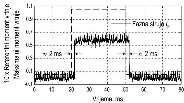
Slika 7.3 Odziv fazne struje motora za skokovitu promjenu momenta vrtnje uz zakočeni rotor motora ( $n=0$ ).
