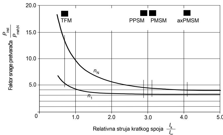
Slika 2.13 Dimenzioniranje frekvencijskih pretvarača pri preopterećenju preko relativne struje kratkog spoja
