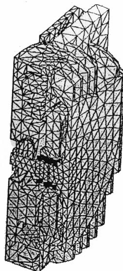
Slika 4.11 Topološka optimizacija pogonskog uređaja lifta [12]
