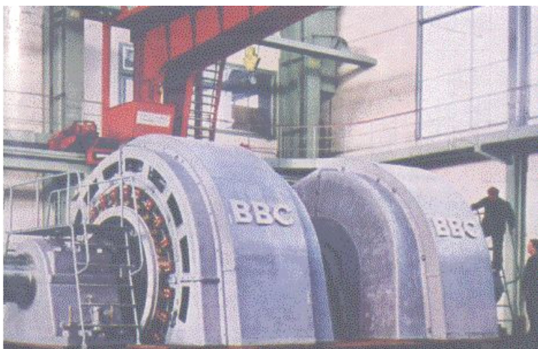
Slika 2.1 Direktni pogon valjaoničkog stana 6
