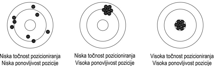
Slika 5.8 Točnost pozicioniranja i ponovljivosti pozicije pogona
