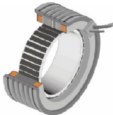
Slika 5.3 Visokomomentni motor
