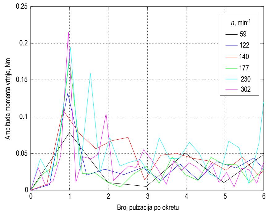
Slika 7.12 Valovitost momenta uslijed debalansa rotora motora (detalj slike 7.9)
