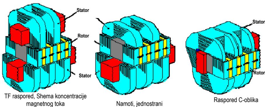
Slika 2.6 Princip izvedbe motora s transverzalnim protokom
