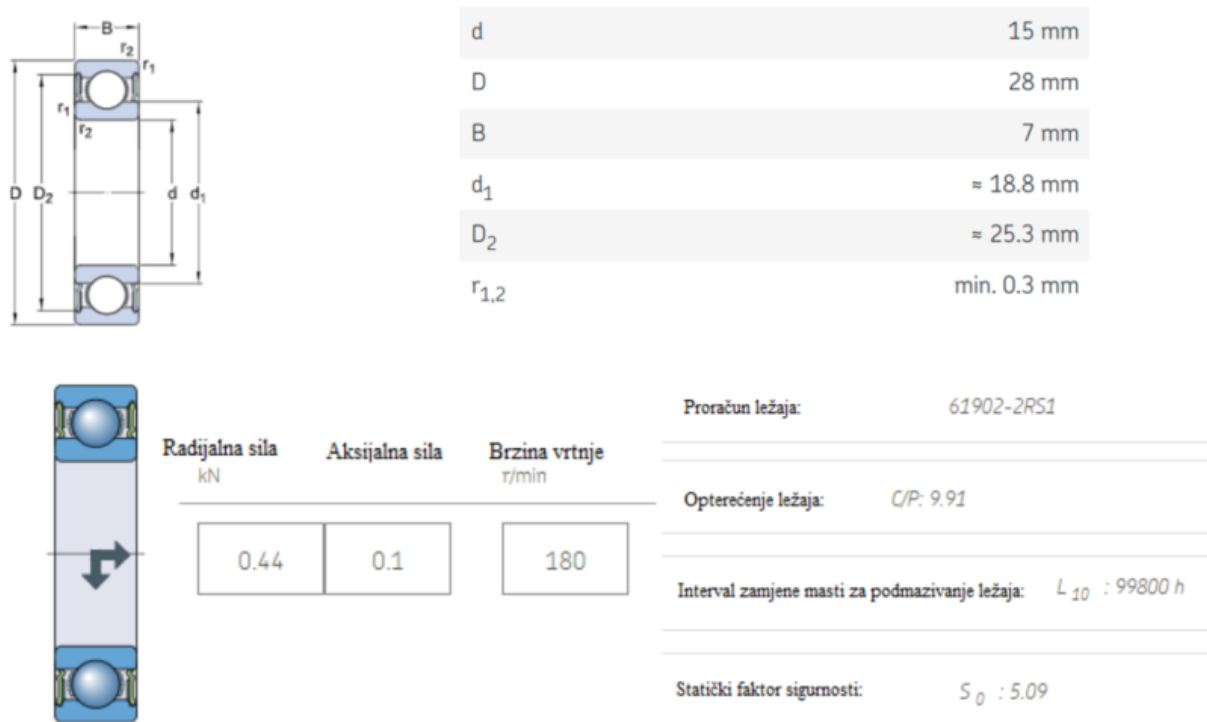
Slika 79. Odabir i proračun jednorednog kugličnog ležaja [39]
