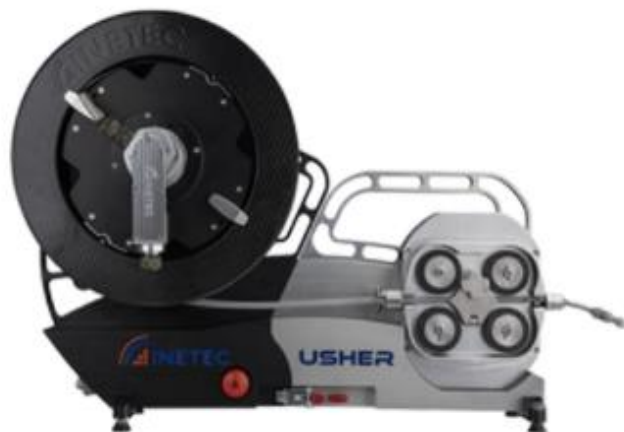
Slika 8. Uređaj tvrtke INETEC namijenjen postavljanju i vođenju sonde u cijevi [11]
