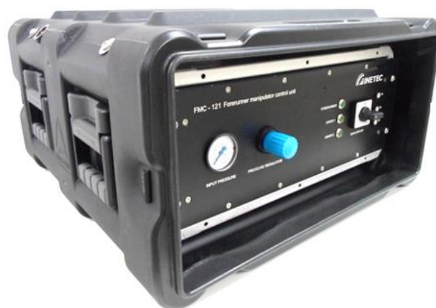
Slika 16. Jedinica za napajanje i upravljanje FMC-121 [11]
