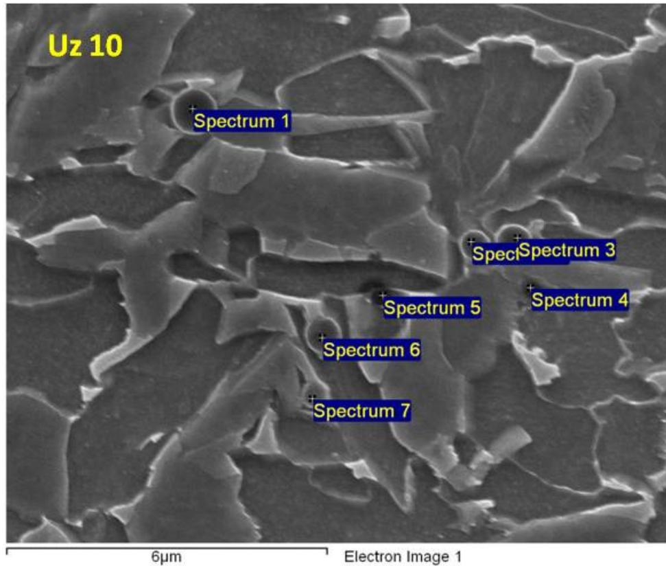
Slika 79: Ispitna mjesta EDS analize provedene na uzorku stanja pokusa 10, stanje s maksimalnim udjelom CO<sub>2</sub> u zaštitnom plinu
