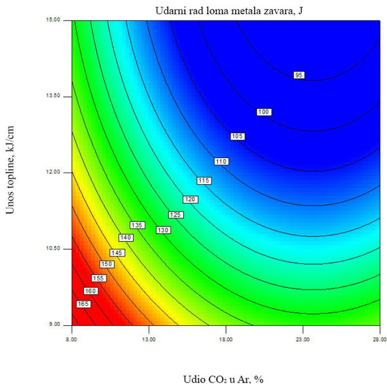
Slika 85: Konturni prikaz modela ovisnosti udarnog rada loma metala zavara o parametrima zavarivanja uz  $\vartheta = 20\text{ }^{\circ}\text{C}$
