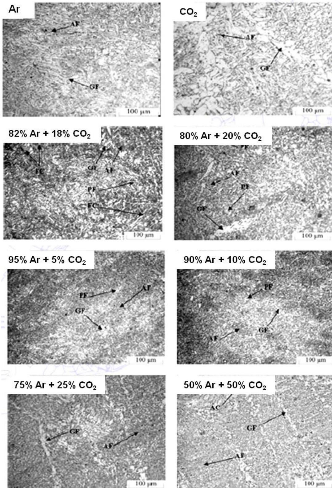
Slika 32: Mikrostruktura zavora dobivenih s različitim mješavinama zaštitnih plinova Ar i CO<sub>2</sub> [59]
