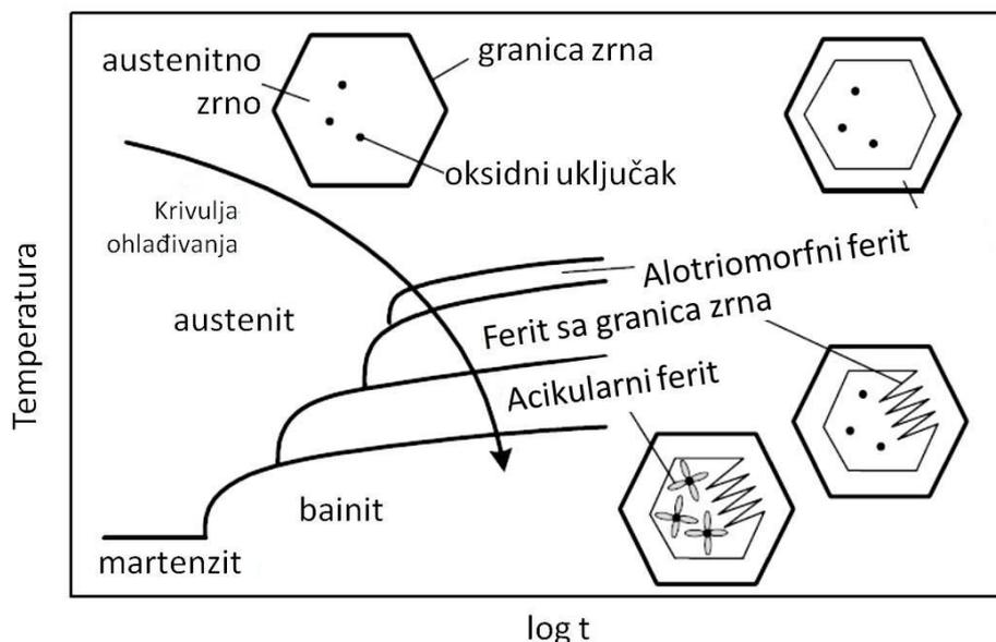
Slika 116: TTT dijagram za metal zavara niskougličnog čelika [83]
