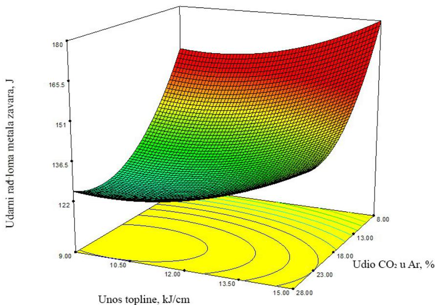
Slika 90: 3D prikaz modela ovisnosti udarnog rada loma metala o parametrima zavarivanja uz  $\vartheta = 140\text{ }^{\circ}\text{C}$
