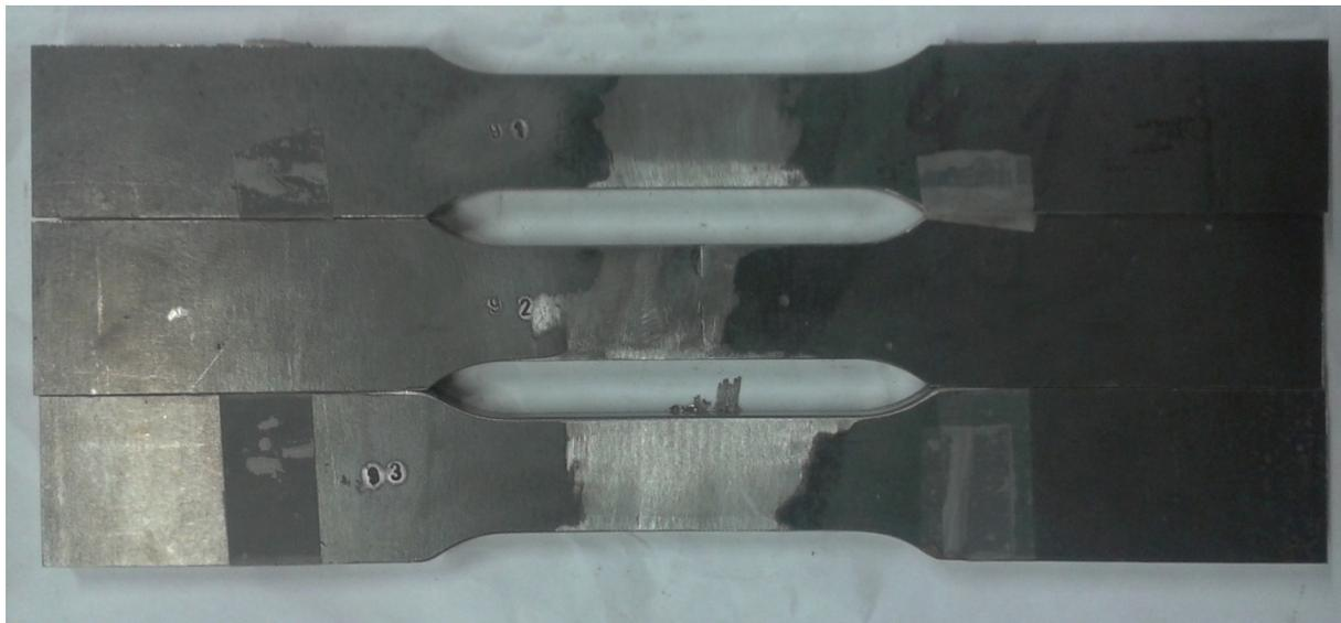
Slika 51: Ispitni uzorci za statičko vlačno ispitivanje
