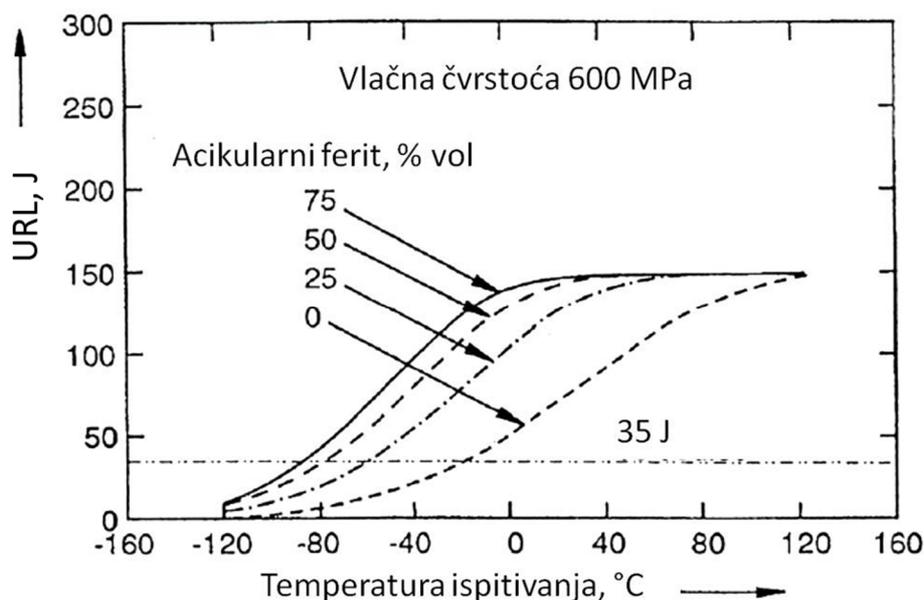
Slika 124: Utjecaj acikularnog ferita u metalu zavara na krivulje prijelazne temperature udarnog rada loma [91]
