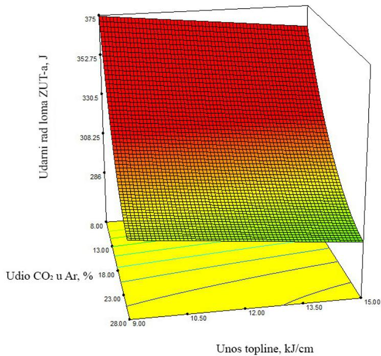
Slika 100: 3D prikaz modela ovisnosti udarnog rada loma ZUT-a o parametrima zavarivanja uz  $\vartheta = 140\text{ }^{\circ}\text{C}$
