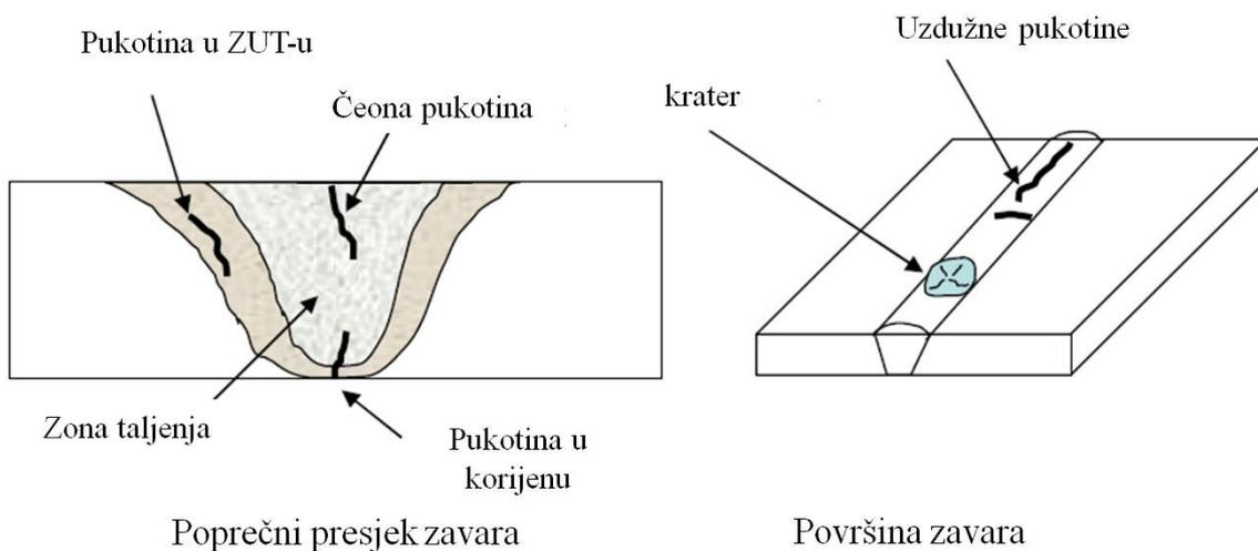
Slika 18: Tople pukotine u zavarenom spoju [36]
