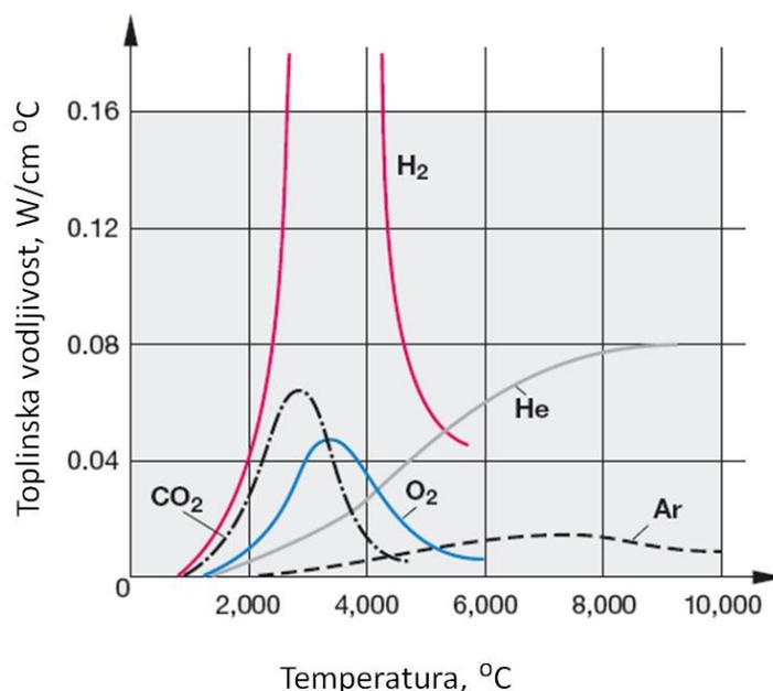
Slika 29: Toplinska vodljivost plinova u ovisnosti o temperaturi [56]
