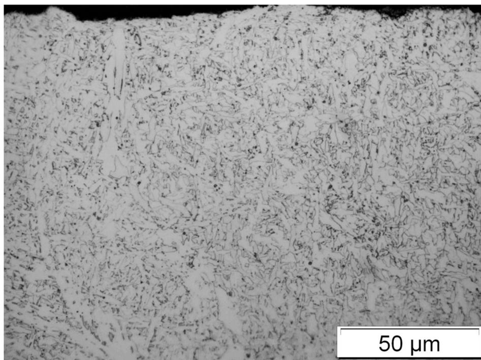
Slika 127: Mikrostruktura metala zavara uzorka stanja pokusa 12
