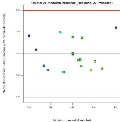
Slika 104: Slučajno rasipanje ostataka u odnosu na modelom izračunate (predviđene) vrijednosti za rezultate širine ZUT-a
