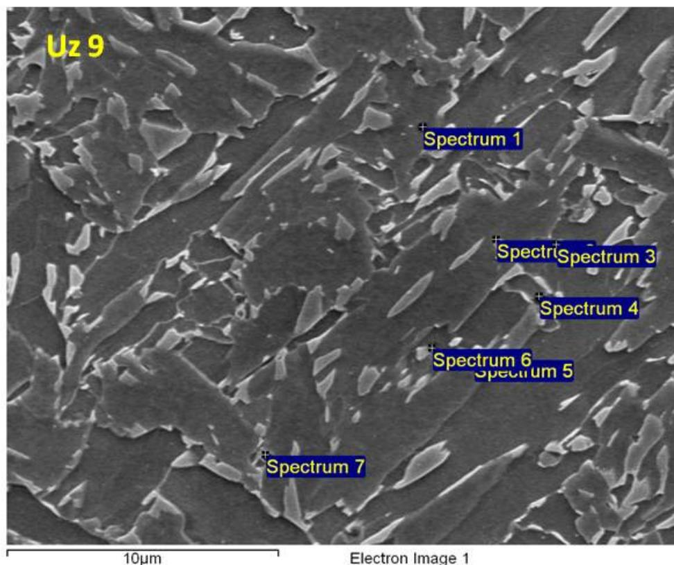
Slika 78: Ispitna mjesta EDS analize provedene na uzorku stanja pokusa 9, stanje s minimalnim udjelom CO<sub>2</sub> u zaštitnom plinu
