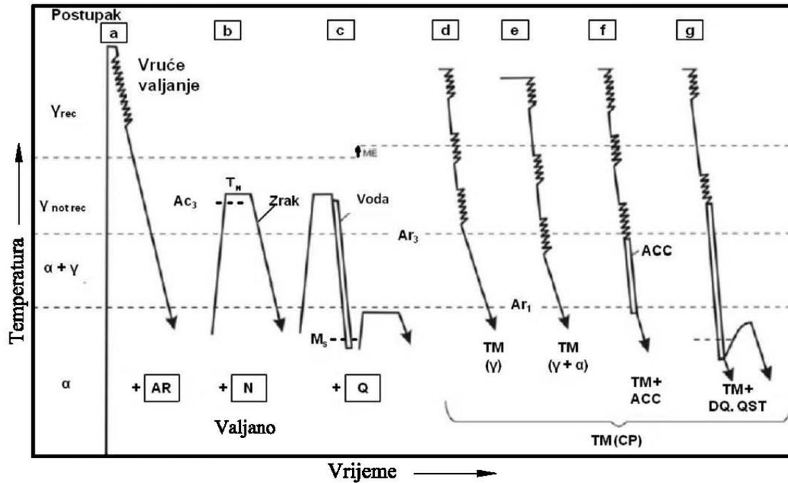
Slika 6: Usporedba klasičnih postupaka valjanja konstrukcijskih čelika i TMCP postupka [29]
