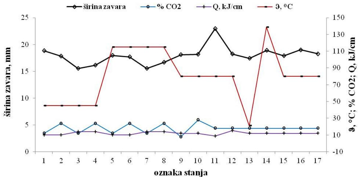
Slika 63: Ovisnost širine zavara o parametrima zavarivanja
