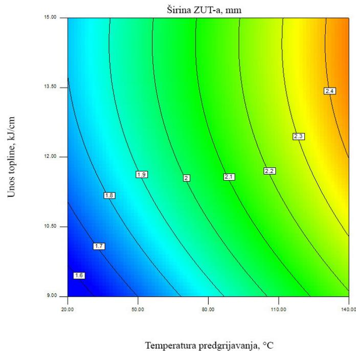
Slika 107: Konturni prikaz modela ovisnosti širine ZUT-a o parametrima zavarivanja uz udio CO<sub>2</sub> u zaštitnom plinu 23 %
