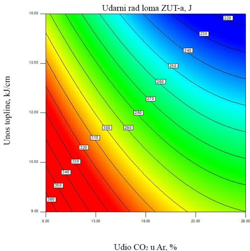
Slika 95: Konturni prikaz modela ovisnosti udarnog rada loma ZUT-a o parametrima zavarivanja uz  $\vartheta = 20 \text{ }^\circ\text{C}$
