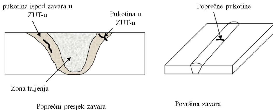
Slika 19: Hladne pukotine u zavarenom spoju [36]
