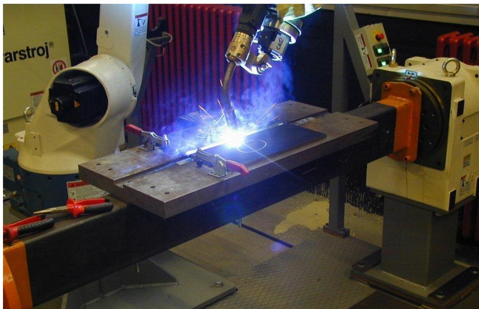
Slika 44: Zavarivanje uzorka robotskom jedinicom Almega AX V6
