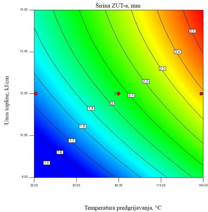
Slika 106: Konturni prikaz modela ovisnosti širine ZUT-a o parametrima zavarivanja uz udio CO<sub>2</sub> u zaštitnom plinu 18 %
