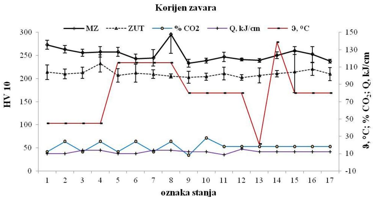
Slika 60: Tvrdoća zavarenog spoja u području korijena zavara
