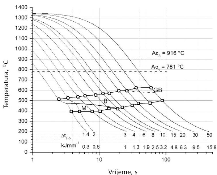
Slika 129: TTT dijagram ĉelika X80, temperatura zagrijavanja 1350 °C [101]
