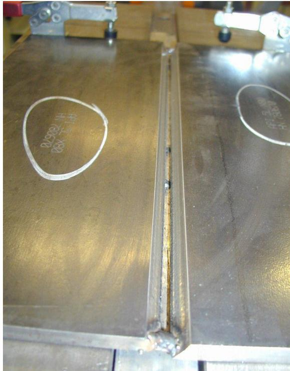
Slika 46: Priprema zavarenog spoja
