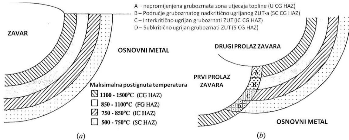
Slika 128: Shematski prikaz mikrostrukture u
