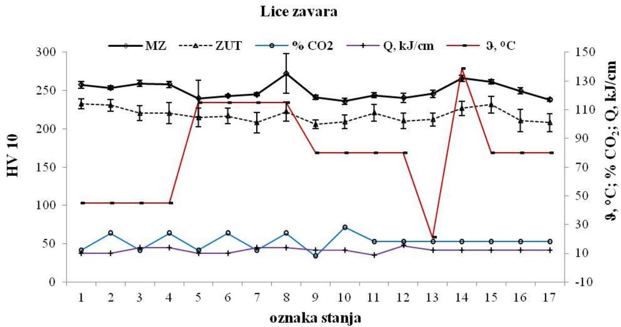
Slika 59: Tvrdoća zavarenog spoja u području lica zavara
