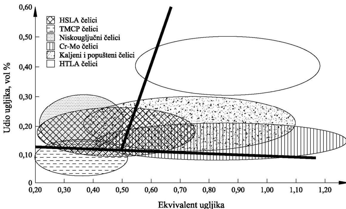
Slika 13:  $C_{ekv}$  različitih vrsta čelika [34]
