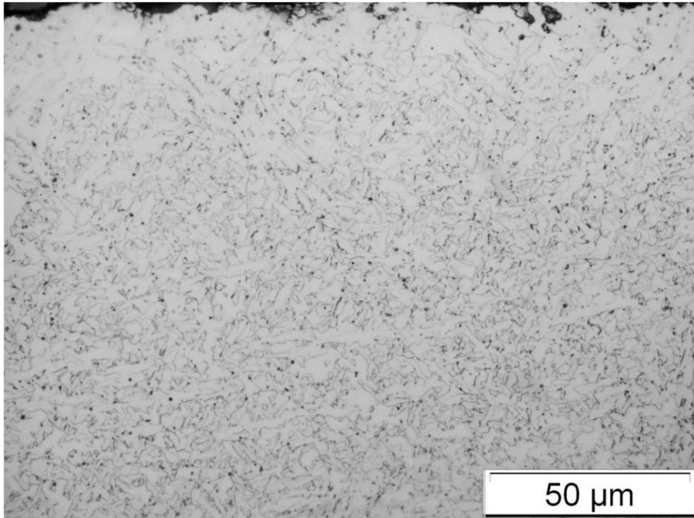
Slika 125: Mikrostruktura metala zavara uzorka stanja pokusa 9
