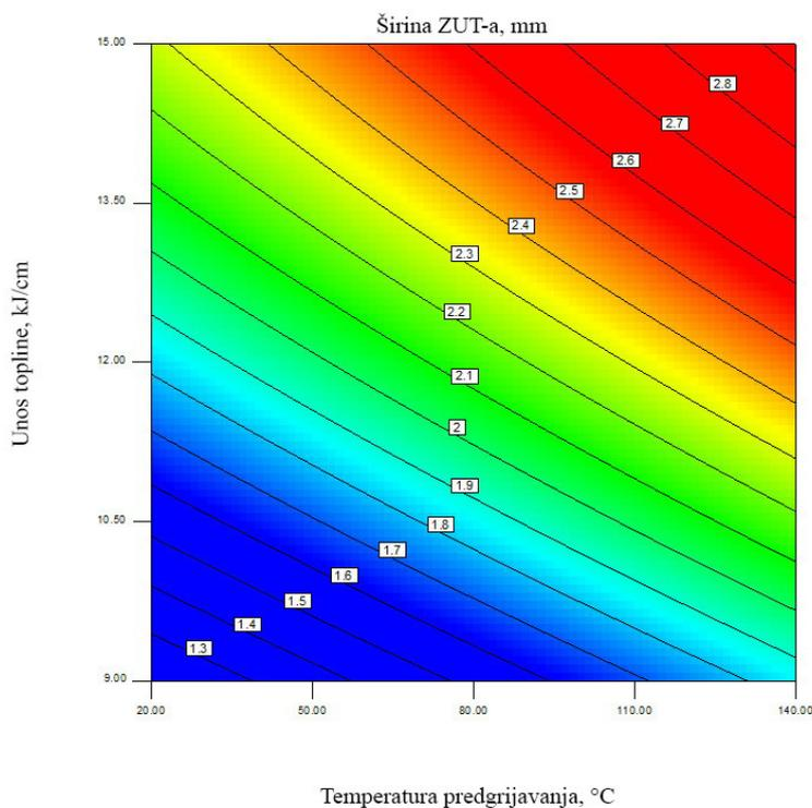
Slika 105: Konturni prikaz modela ovisnosti širine ZUT-a o parametrima zavarivanja uz udio CO<sub>2</sub> u zaštitnom plinu 8 %
