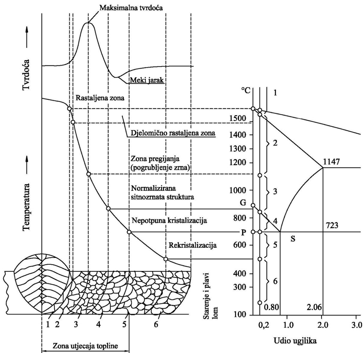
Slika 25: ZUT zavarenog spoja nelegiranog niskougljičnog feritno - perlitnog čelika s 0.2 %C
