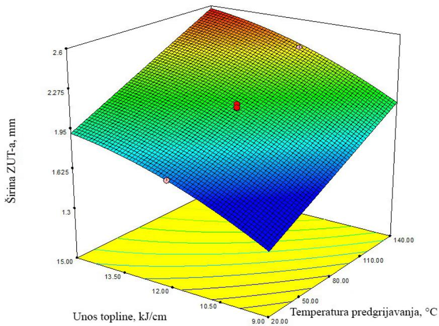
Slika 110: 3D prikaz modela ovisnosti širine ZUT-a o parametrima zavarivanja uz udio CO<sub>2</sub> u zaštitnom plinu 18 %
