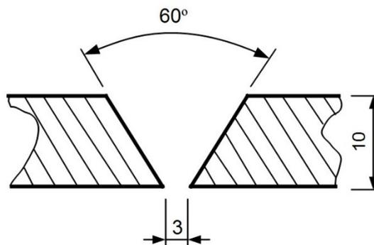
Slika 45 : Priprema zavarenog spoja
