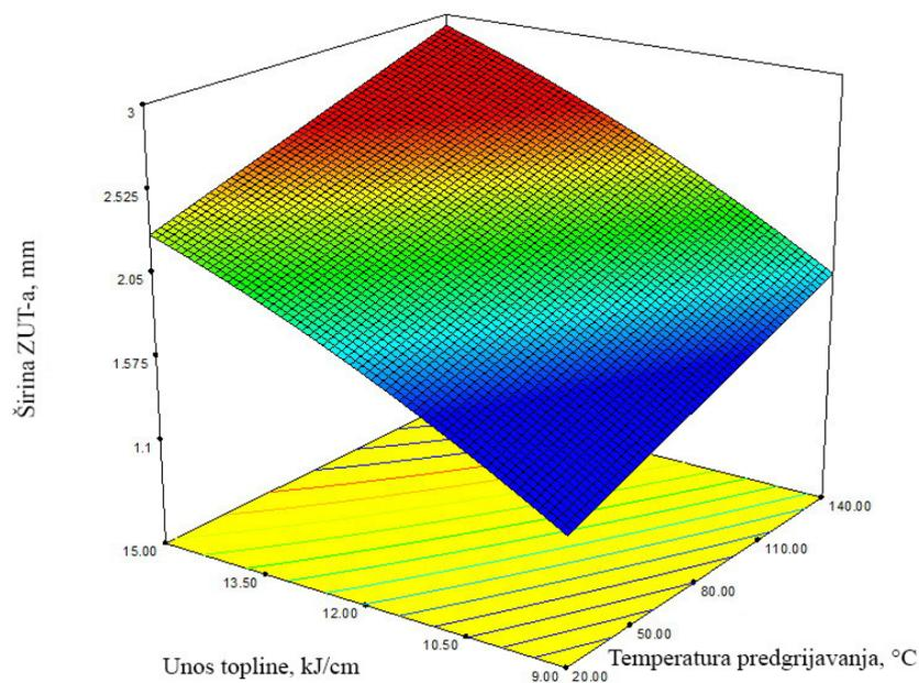
Slika 109: 3D prikaz modela ovisnosti širine ZUT-a o parametrima zavarivanja uz udio  $\text{CO}_2$  u zaštitnom plinu 8 %
