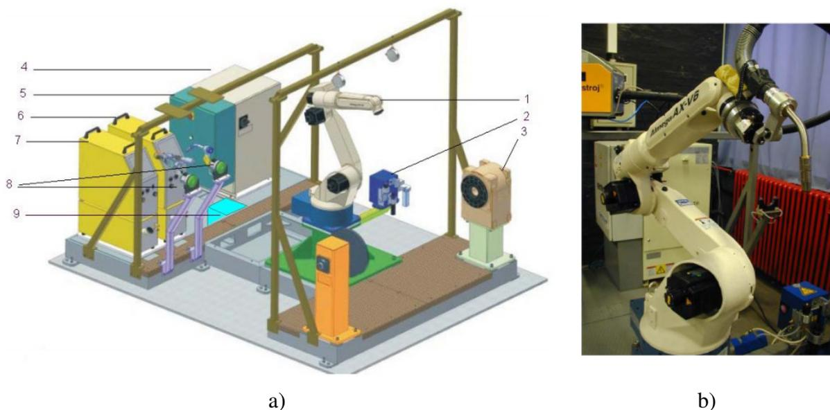
Slika 43: Robotska jedinica za zavarivanje
