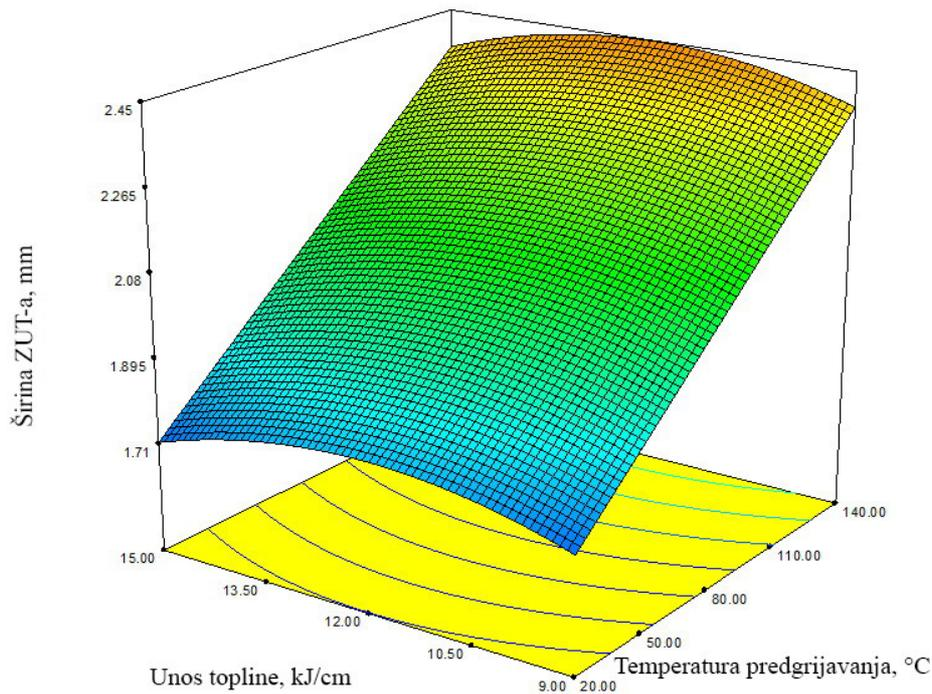
Slika 112: 3D prikaz modela ovisnosti širine ZUT-a o parametrima zavarivanja uz udio CO<sub>2</sub> u zaštitnom plinu 28 %
