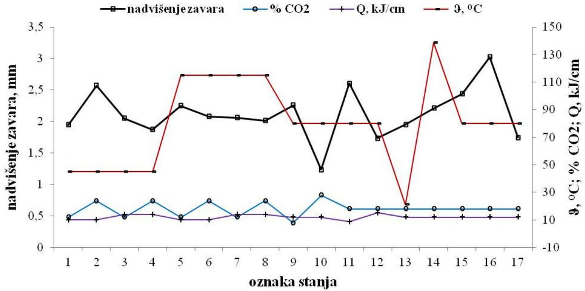
Slika 64: Ovisnost nadvišenja zavara o parametrima zavarivanja
