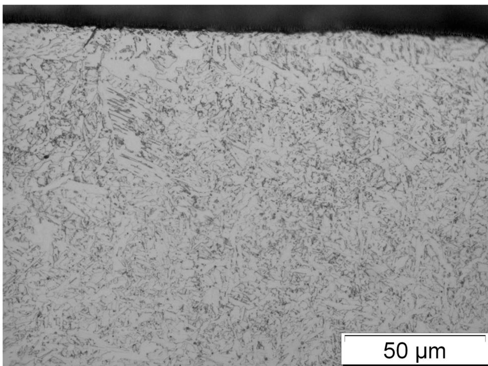
Slika 126: Mikrostruktura metala zavara uzorka stanja pokusa 10
