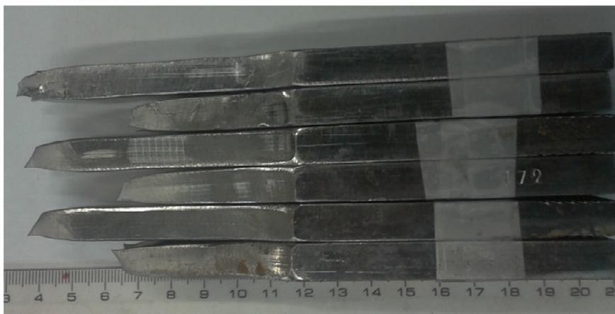
Slika 55: Ispitni uzorci nakon provedenog statičnog vlačnog ispitivanja
