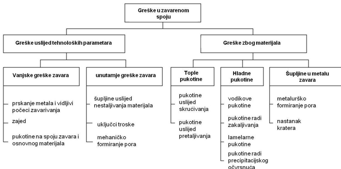
Slika 14: Vrste grešaka u zavarenom spoju [36]
