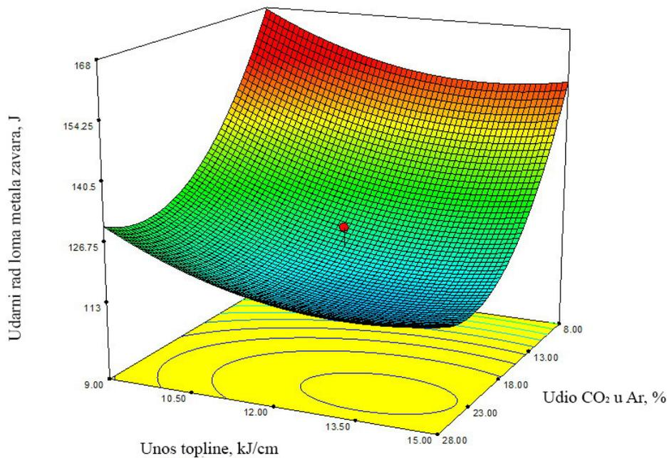
Slika 89: 3D prikaz modela ovisnosti udarnog rada loma metala zavara o parametrima zavarivanja uz  $\vartheta = 80\text{ }^{\circ}\text{C}$
