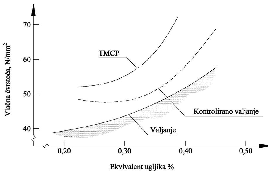
Slika 10: Odnos ekvivalenta ugljika ( $C_{ekv}$ ) i vlačne čvrstoće [25]
