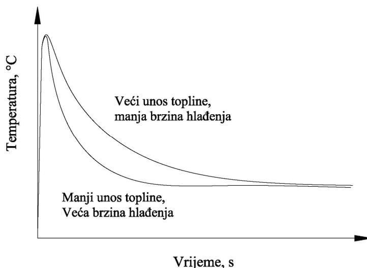
Slika 35: Utjecaj unosa topline na brzinu ohlađivanja [61]
