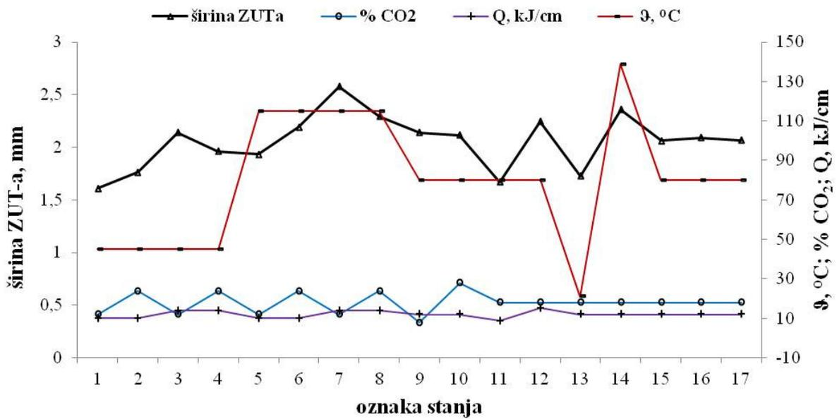
Slika 65: Ovisnost širine ZUT-a zavara o parametrima zavarivanja
