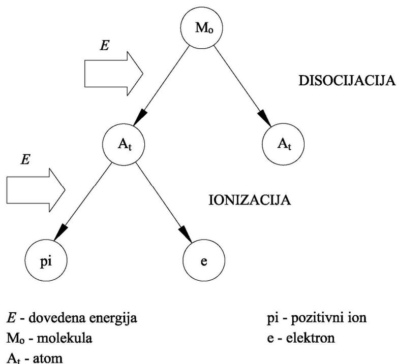
Slika 30: Pojednostavljeni shematski prikaz disocijacije i ionizacije [51]
