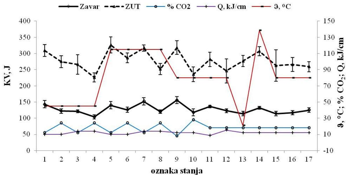
Slika 57: Ovisnost udarnog rada loma zavara i ZUT-a o parametrima zavarivanja
