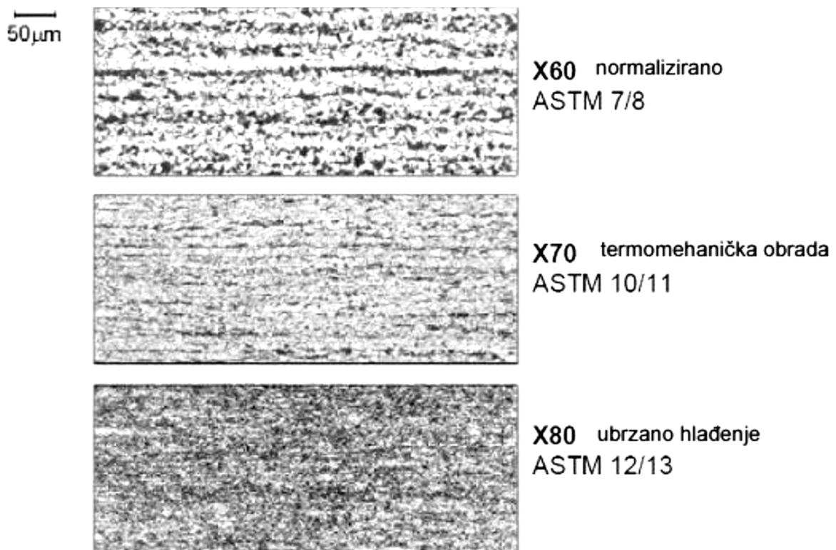
Slika 41: Mikrostrukture API 5L X čelika [72]
