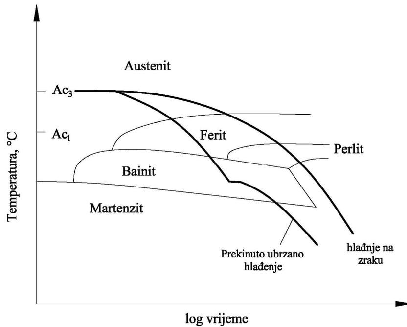
Slika 9: TTT dijagram s usporedbama brzina ohlađivanja [30]
