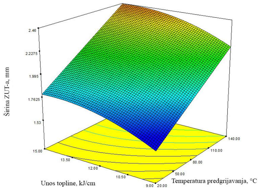
Slika 111: 3D prikaz modela ovisnosti širine ZUT-a o parametrima zavarivanja uz udio CO<sub>2</sub> u zaštitnom plinu 23 %
