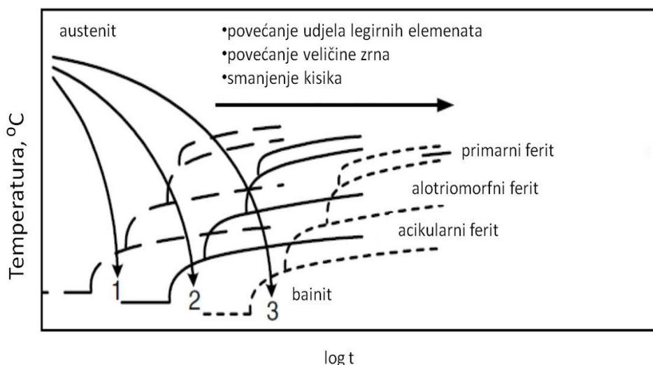
Slika 121: Prikaz utjecaja legirnih elemenata, veličine zrna i kisika na mikrostrukturu u TTT dijagramu zavara niskougljičnog čelika [83]
