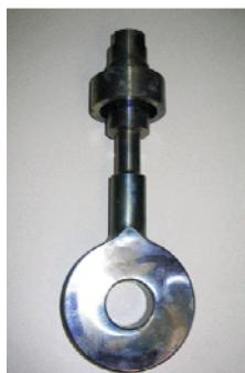
**Slika 30.** *Posebna izvedba roga za ispitivanje učinkovitosti ultrazvuka velike snage u protočnom eksperimentalnom sustavu*
