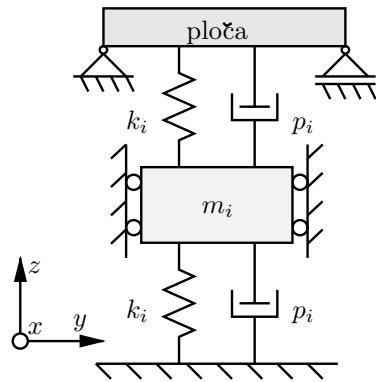
Slika 5.5: Dinamički prigušivač vibracija ploče
