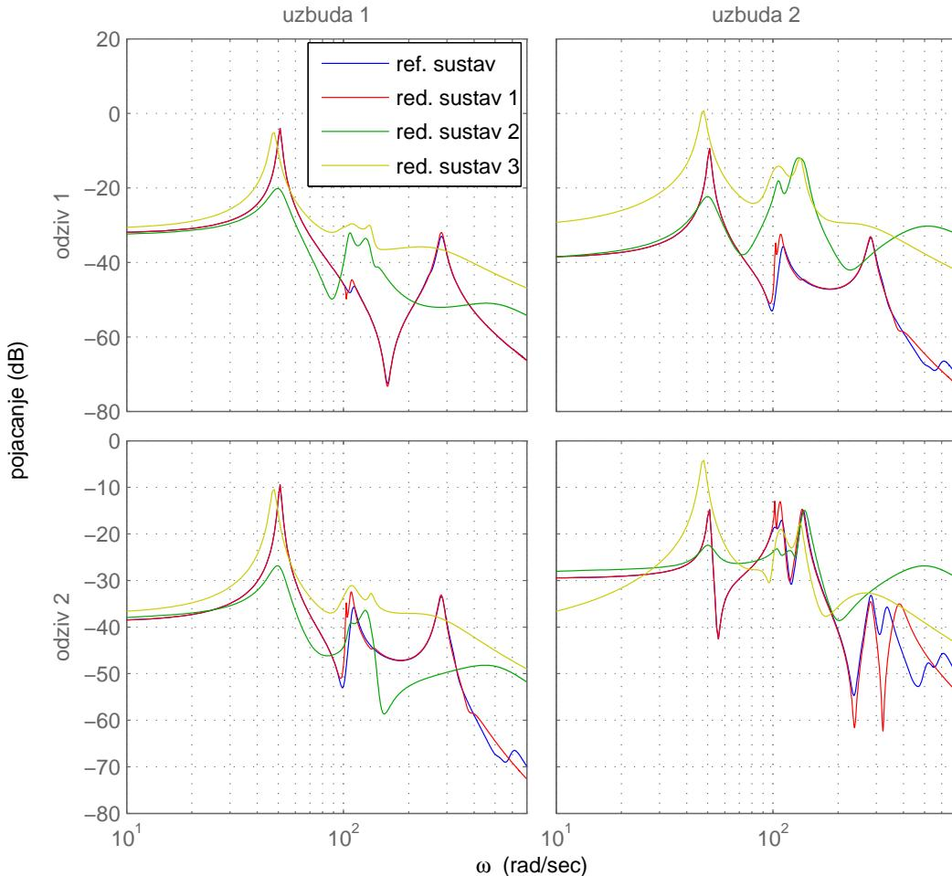
Slika 5.6: Bodeovi dijagrami pojačanja za reducirane sustave 1–3 i referentni sustav
