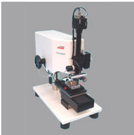
Slika 5.39. Uređaj REVETEST, CSEM, Švicarska, za provođenje testa brazdanja, [64]
