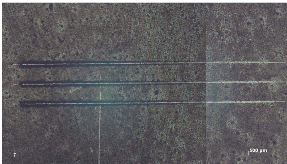
Slika 5.40. Test brazdanjem na ispitnom uzorku A (700°C, 8 slojeva ZrO 2 prevlake) - tragovi testa brazdanja na ispitnom uzorku
