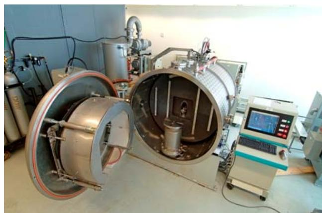
Slika 3.13. Postrojenje za naštrcavanje plazmom u vakuumu, [45]
