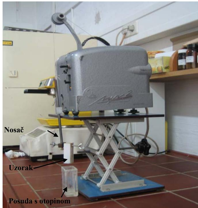
Slika 5.3. Uređaj za uranjanje uzorka
