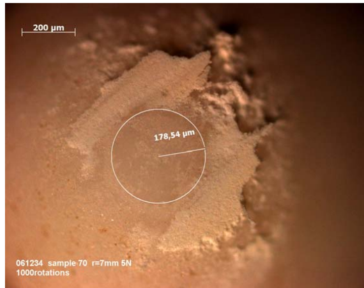
Slika 5.51. Trag trošenja na kuglici
