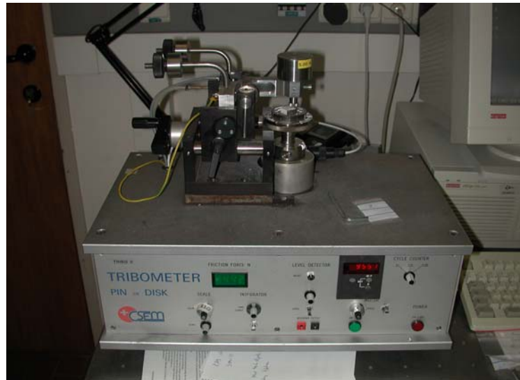
Slika 5.53. CSEM tribometer - TRIBO II
