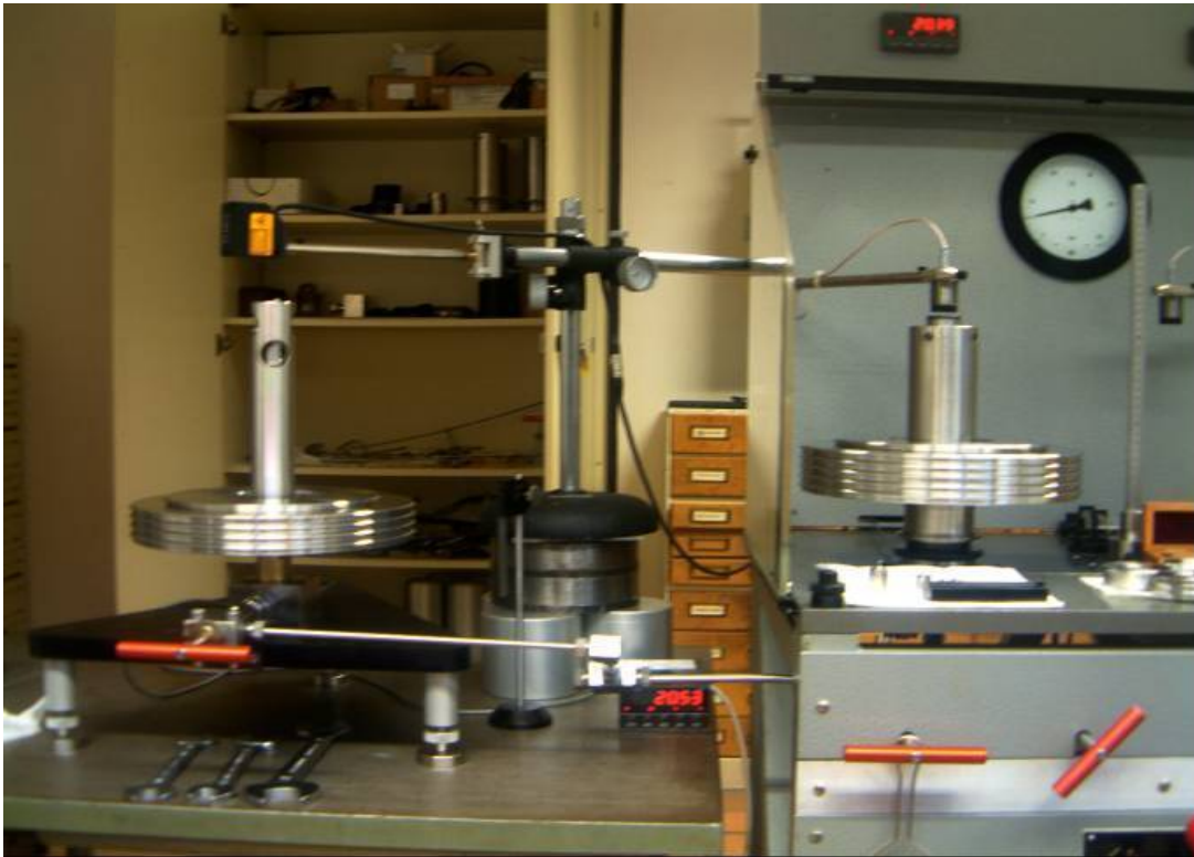
Slika 3-10: Eksperimentalno određivanje efektivne površine sklopa X0467
