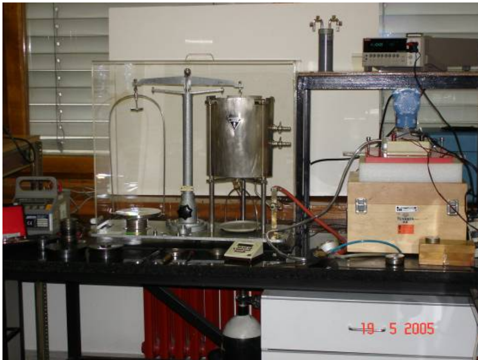
Slika 3-13: Određivanje površine zvonastog manometra TLVAG-05
