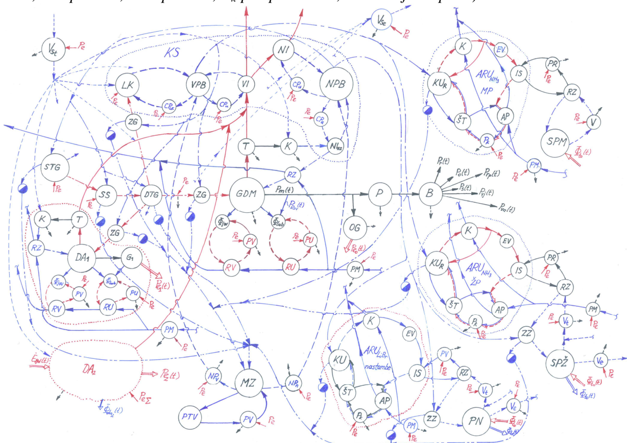
Slika 2.3 Pojednostavnjena energetska mreža dizel-motornog trigeneracijskog sustava broda
