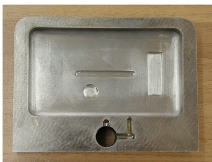
Slika 9.7 Prilagođen uljevni sustav prototipne matrice
