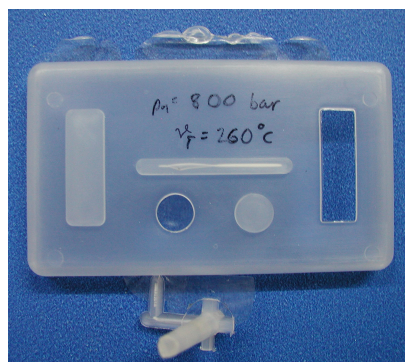
Slika 9.24 Pojava srha na otpresku (klasični kalup): p_n = 800 bar i T_f = 260 °C
