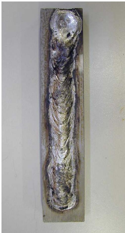
**Slika 3.11** Navareni uzorak za određivanje difundiranog vodika -REL
