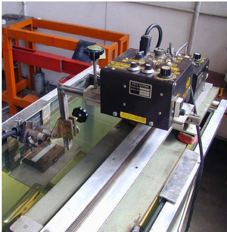
**Slika 3.1** Sustav za automatsko zavarivanje Bugo Systems BUGO-5300 postavljen na laboratorijski bazen
