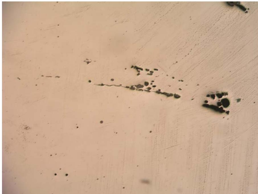
**Slika 4.44** Niz uključaka u metalu zavara- uzorak F135, povećanje 50x,
