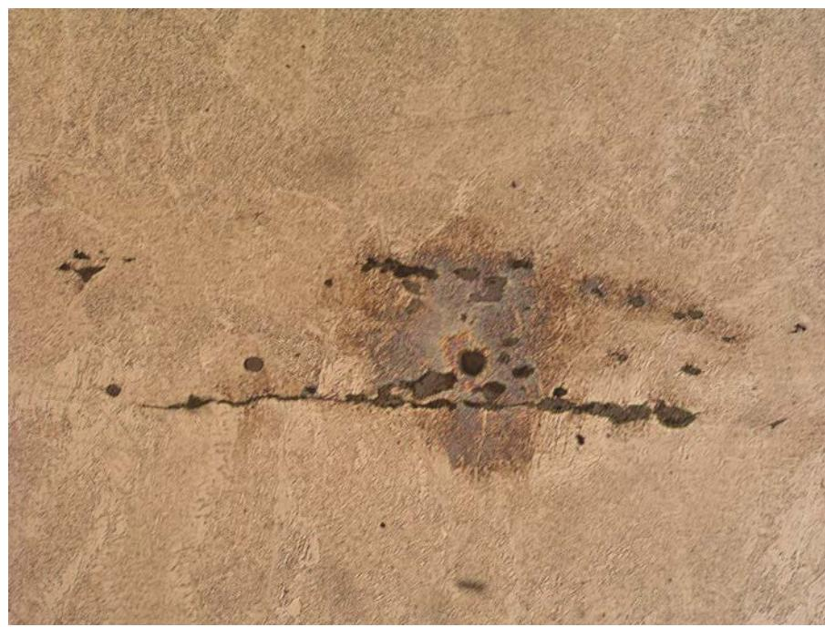
**Slika 4.42** Duguljasti silikatni uključak kao inicijacija pukotine – uzorak F125, povećanje 500x, polirano stanje
