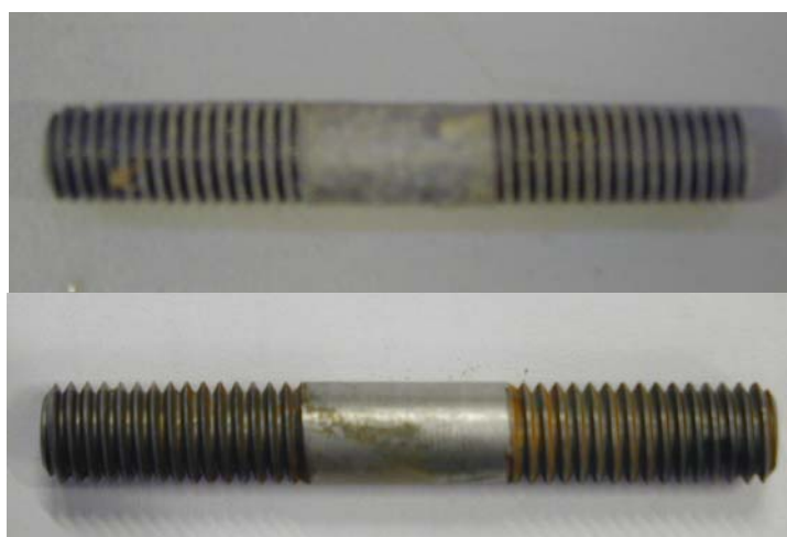
Slika 3.23 Izgled epruvete za Implant test nakon 24 sata u umjetnoj morskoj vodi
