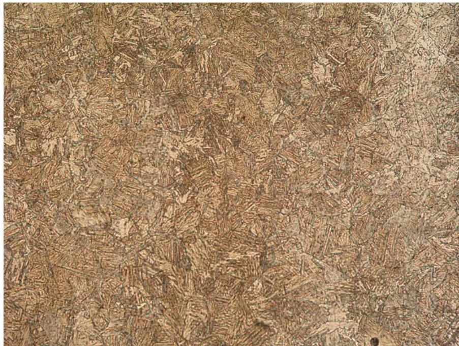
**Slika 4.36** Grubožrnati ZUT –uzorak IB21, povećanje 200x
