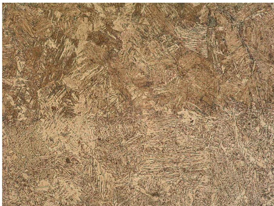
**Slika 4.37** Linija staljivanja –uzorak IB21, povećanje 200x
