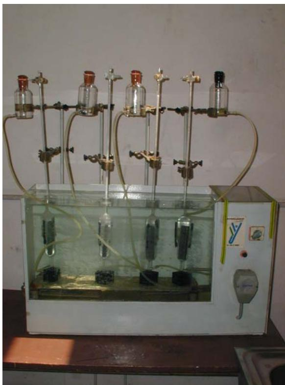
**Slika 3.7** Uređaj za mjerjenje difundiranog vodika glicerinskom metodom
