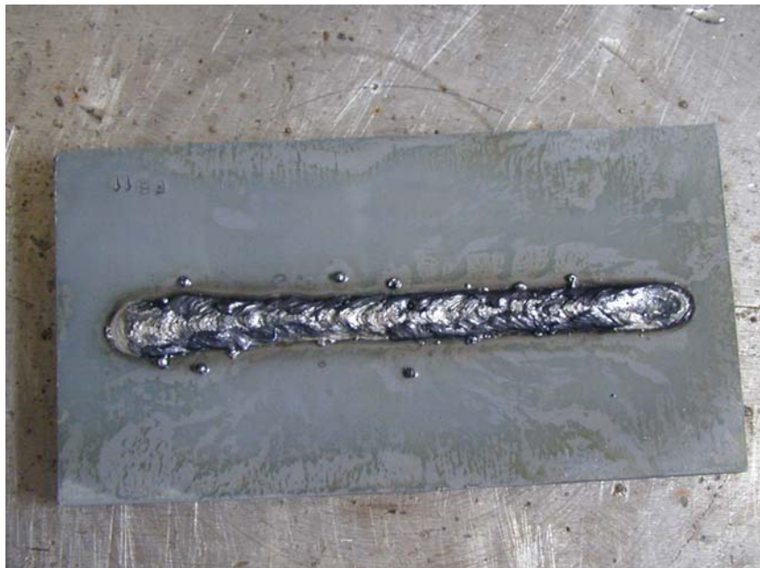
Slika 3.17 Izgled zavarenog uzorka za Implant test –zavarivanje praškom punjenom žicom u plinskoj zaštiti
