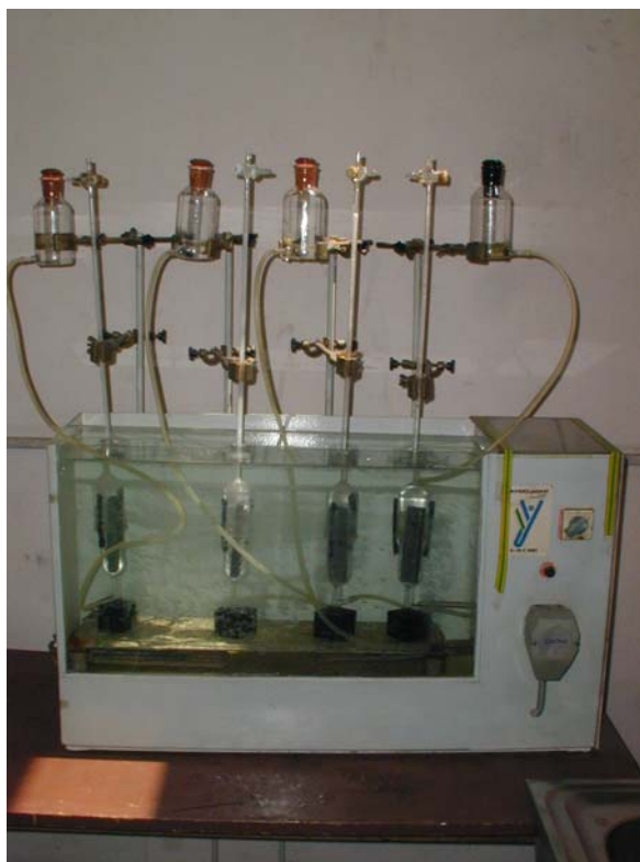
Slika 3.7 Uređaj za mjerenje difundiranog vodika glicerinskom metodom
