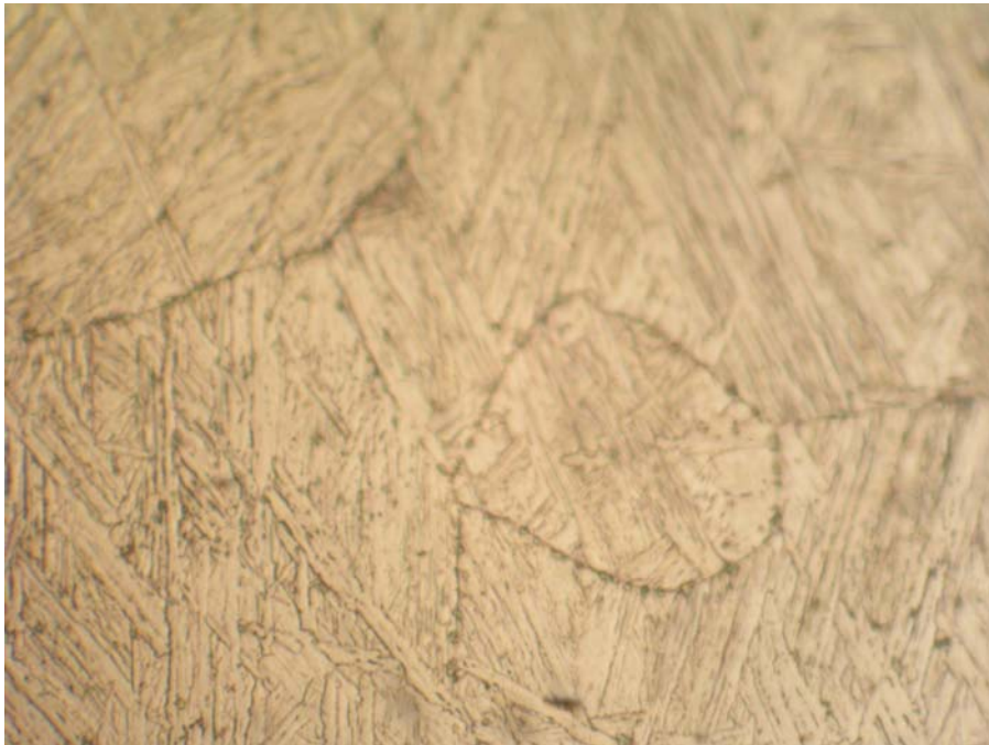
Slika 4.47 Karbidi po granicama zrna kod zavarivanja praškom punjenom žicom u plinskoj zaštiti-uzorak F136, povećanje 1000x
