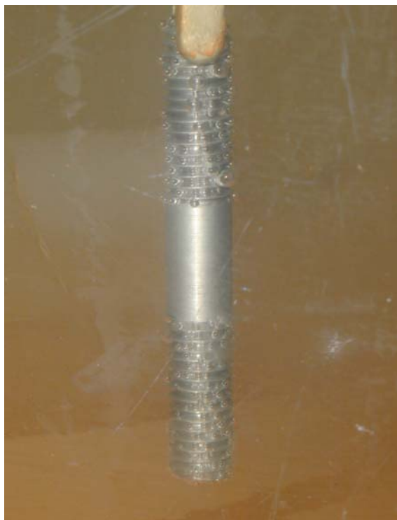
Slika 3.22 Nastajanje vodika na površini Implant uzorka u katodnoj zaštiti
