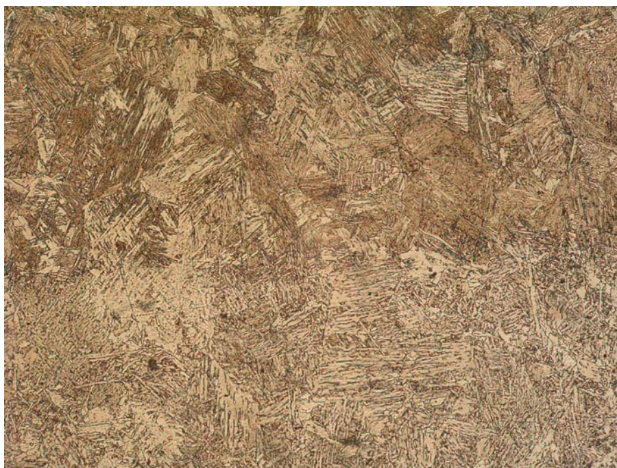
Slika 4.37 Linija staljivanja –uzorak IB21, povećanje 200x
