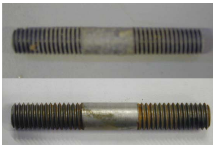
Slika 3.23 Izgled epruветe za Implant test nakon 24 sata u umjetnoj morskoj vodi
