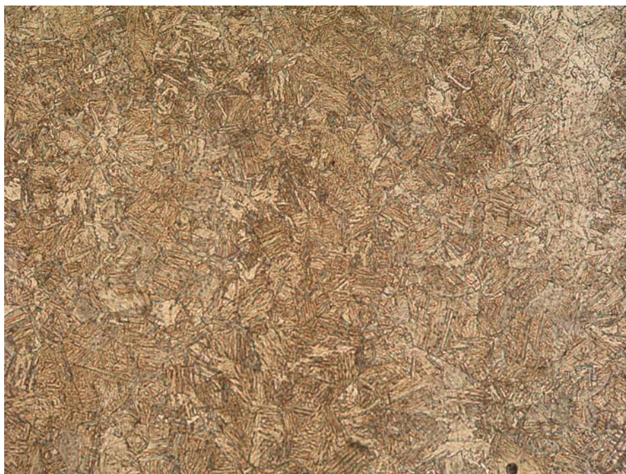
Slika 4.36 Grubozrnati ZUT –uzorak IB21, povećanje 200x
