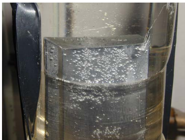
Slika 3.10 Izlučivanje mjehurića vodika iz uzorka
