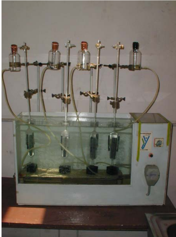
Slika 3.7 Uređaj za mjerenje difundiranog vodika glicerinskom metodom
