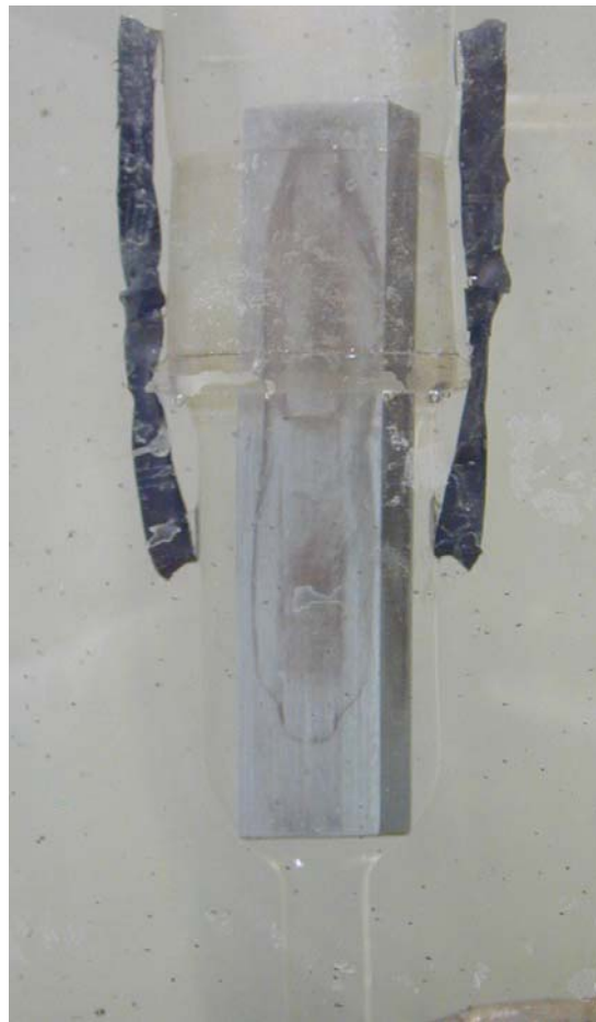
Slika 3.12 Navareni uzorak u uređaju za određivanje difundiranog vodika
