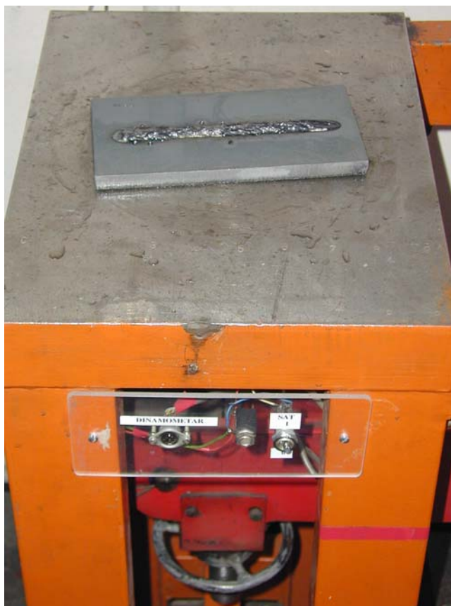
Slika 3.19 Prikaz zavarene ploče s Implant epruvetom pod opterećenjem
