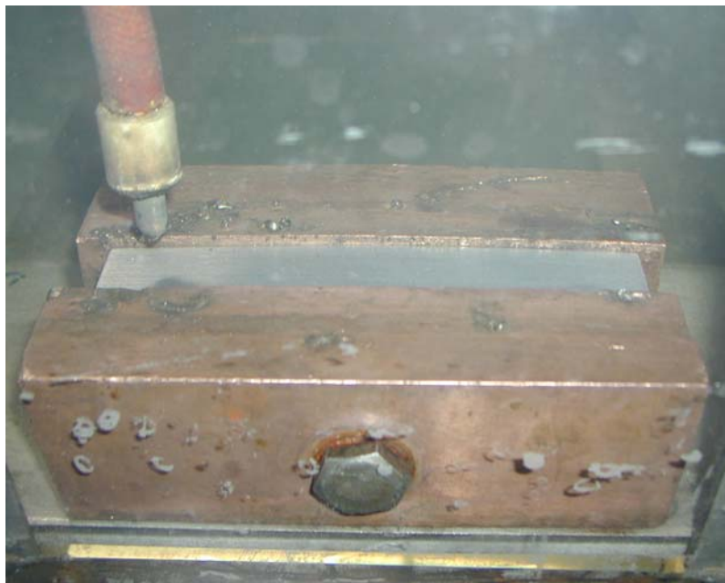
Slika 3.5 Priprema za navarivanje samozaštićujućom praškom punjenom žicom - pozicioniranje pištolja
