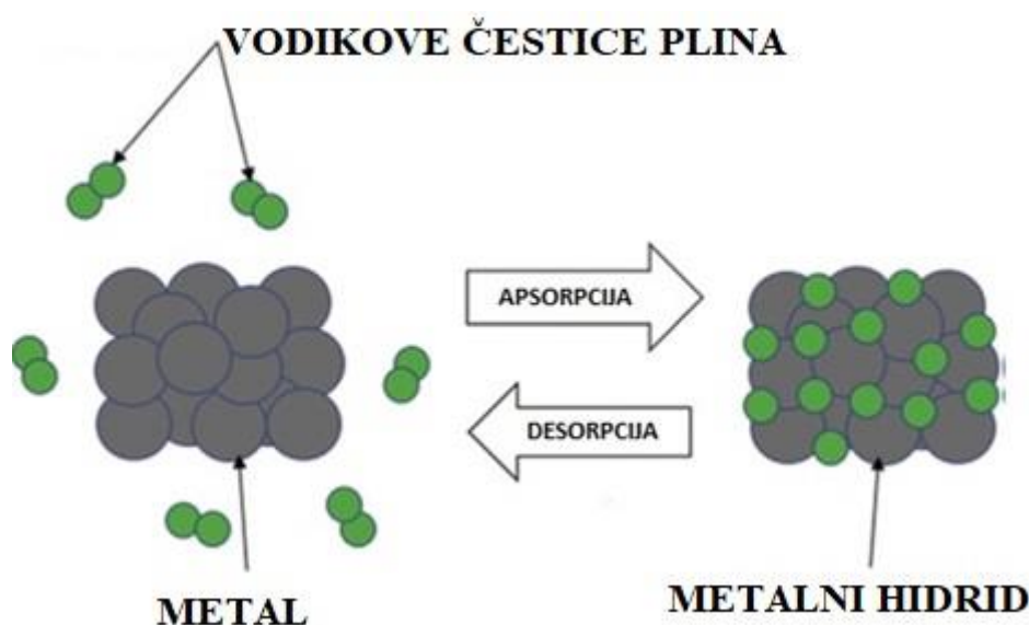
Slika 9: Skladištenje vodika pomoću metalnih hidrida [22].
