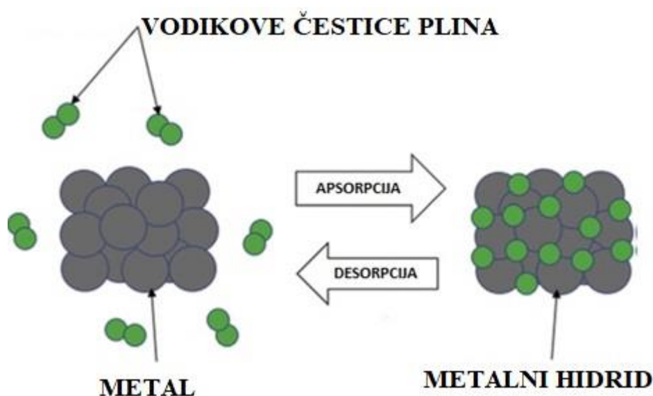
Slika 9: Skladištenje vodika pomoću metalnih hidrida [22].
