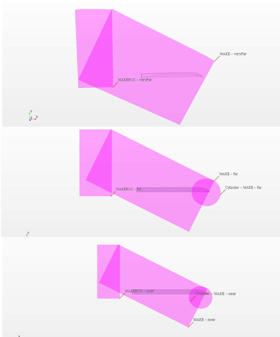
Slika 24. Volumetrijske kontrole za obuhvaćanje Kelvinovog kuta
