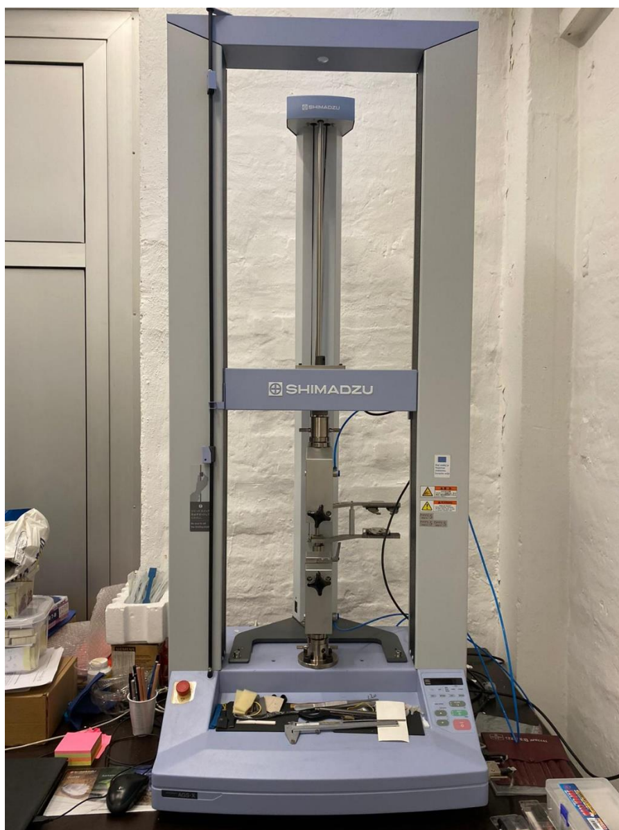
Slika 7.5. Kidalica Shimadzu korištena prilikom ispitivanja
