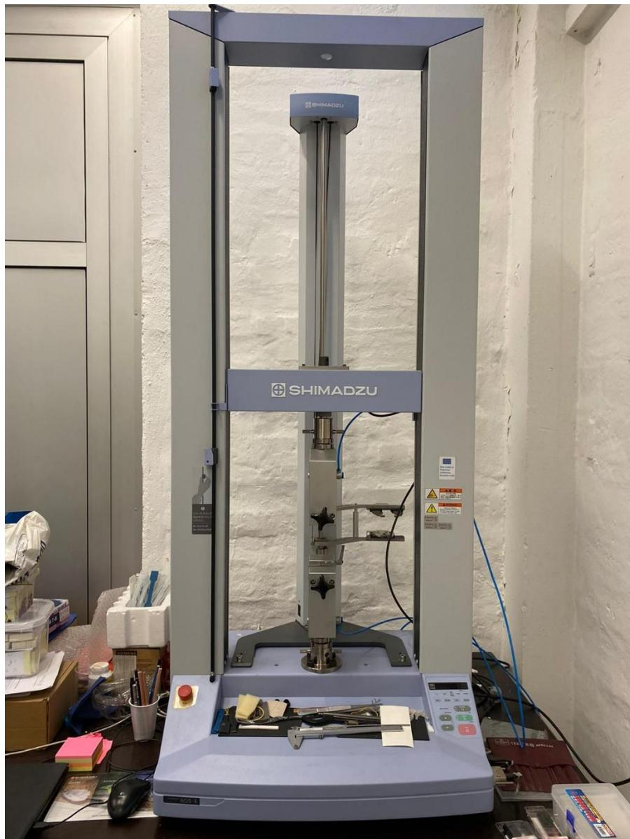
Slika 7.5. Kidalica Shimadzu korištena prilikom ispitivanja
