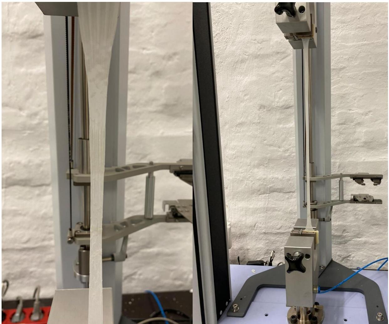
**Slika 7.7. Ispitivanje I. skupine ispita: a) u smjeru ekstrudiranja, b) okomito na smjer ekstrudiranja**
