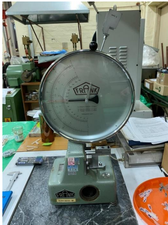
Slika 7.18. Uređaj za ispitivanje rastezne žilavosti – metoda Charpy
