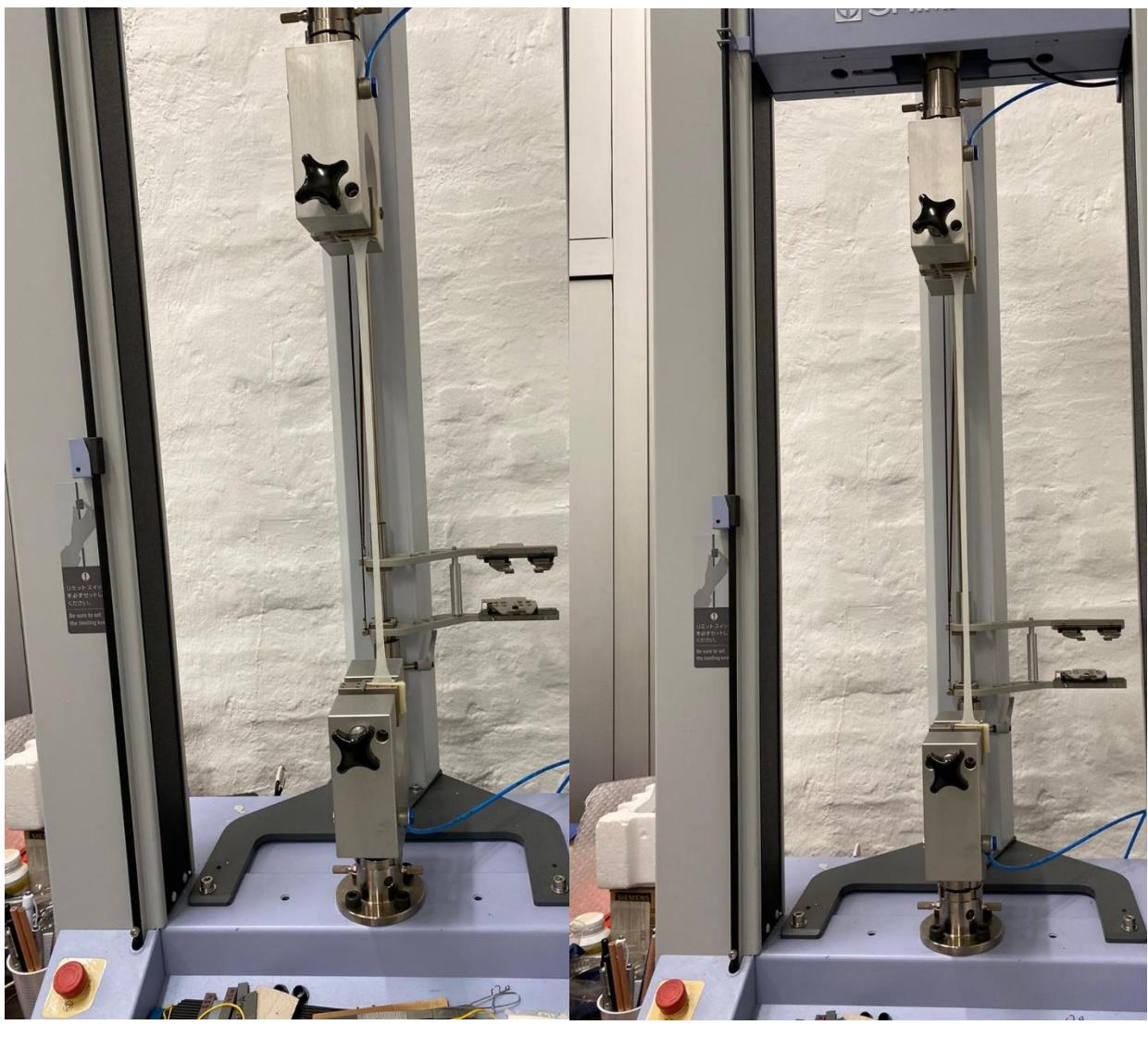
**Slika 7.8. Ispitivanje II. skupine ispitaka: a) u smjeru ekstrudiranja, b) okomito na smjer ekstrudiranja**
