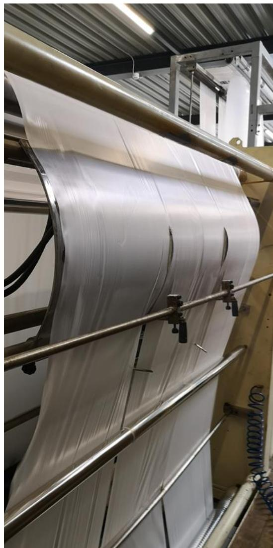
**Slika 3.11. Rezanje crijevnog filma na tri jednake širine**
