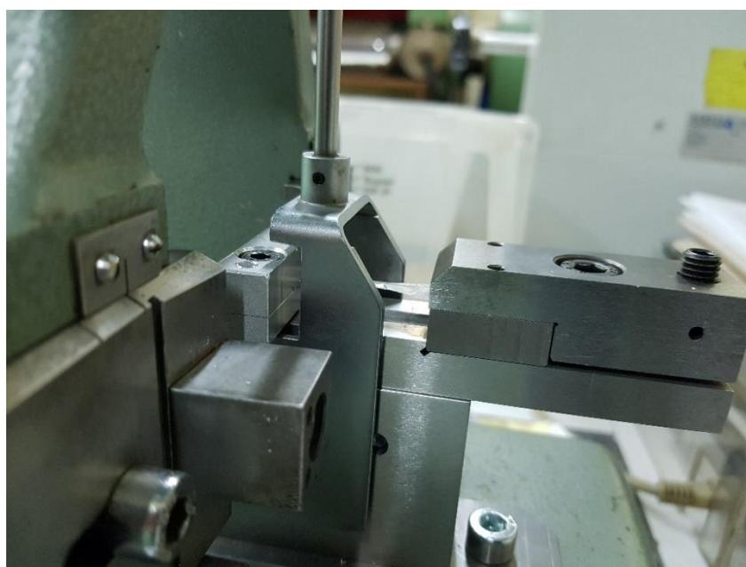
Slika 7.20. Trenutak udara bata na pomični jaram
