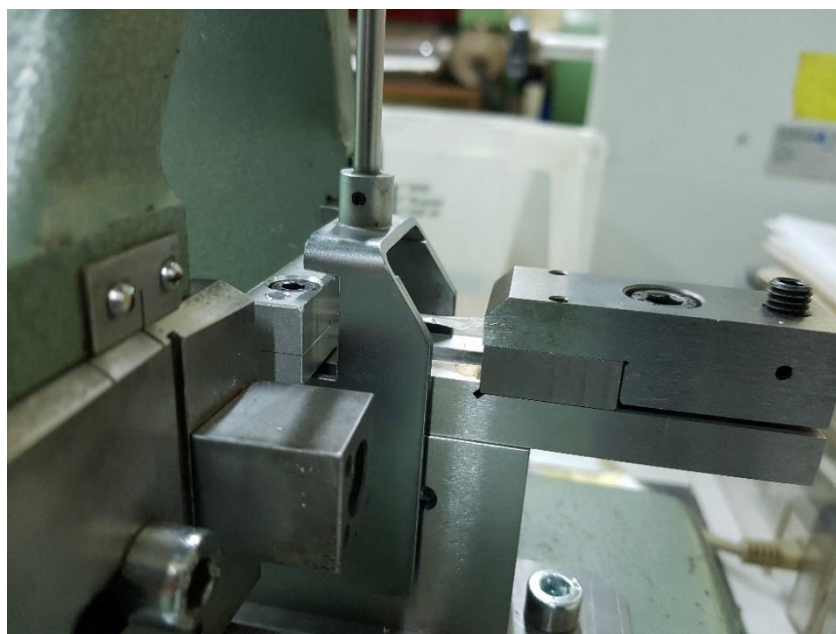
Slika 7.20. Trenutak udara bata na pomični jaram
