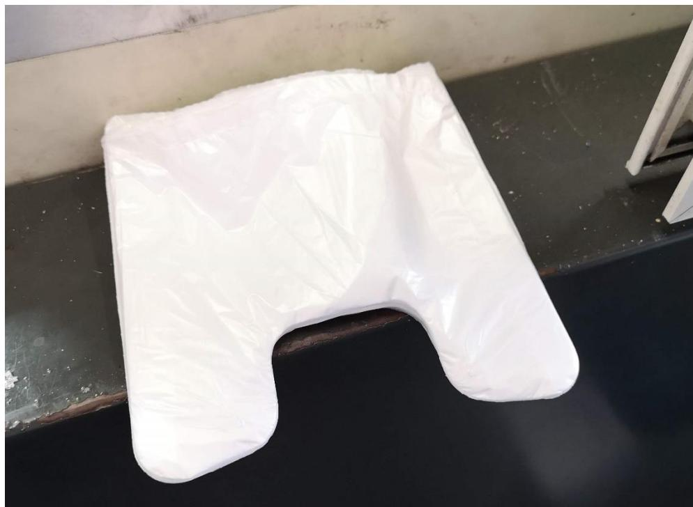
**Slika 3.12. PE-HD plastična vrećica za nošenje s ručkom**
