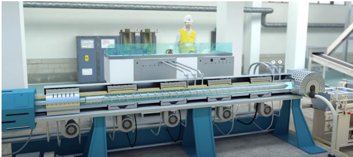
Slika 5.6. Ekstruder za granuliranje [45]
