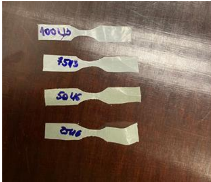
Slika 7.17. Pripremljeni ispiti za ispitivanje rastezne žilavosti
