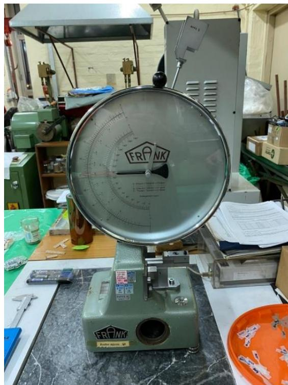
Slika 7.18. Uredaj za ispitivanje rastezne žilavosti – metoda Charpy
