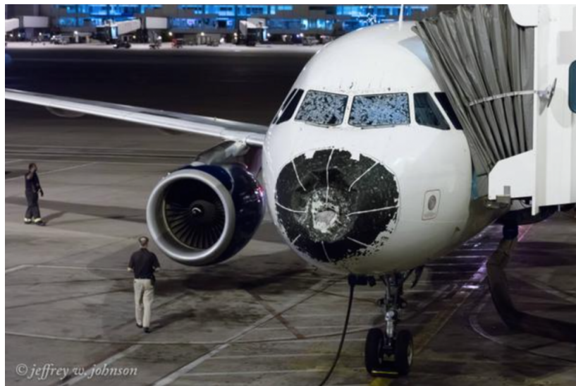
Slika 1.1: Oštećenje na zrakoplovu kao posljedica udara leda [1]
