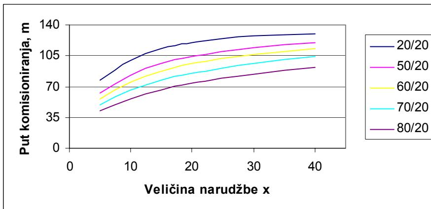
**Slika 4-18.** Put komisioniranja primjenom metode dodijeljenog rasporeda odlaganja u ovisnosti o veličini narudžbe i zakrivljenosti ABC krivulje protoka, primjer ( $N=6$ ,  $L=12$ , optimalna ruta, odlaganje po prolazima)
