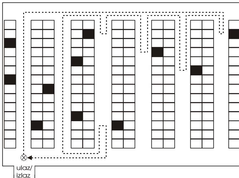
Slika 3-10. Shema rute kretanja dobivene optimalnim algoritmom, primjer
