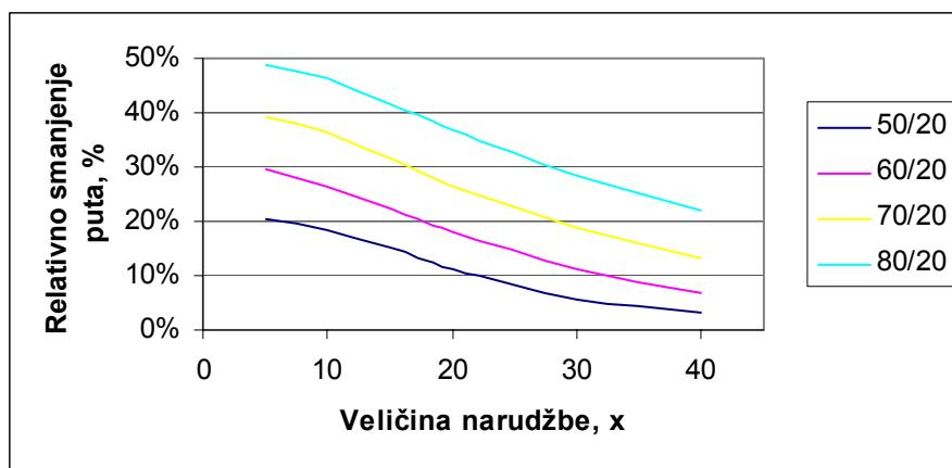
**Slika 4-6.** Relativno smanjenje puta komisioniranja primjenom metode dodijeljenog rasporeda odlaganja u odnosu na slučajni raspored odlaganja ovisno o ABC krivulji protoka i veličini narudžbe, primjer ( $N=6$ ,  $L=12$ , routing prema metodi S-oblika)
