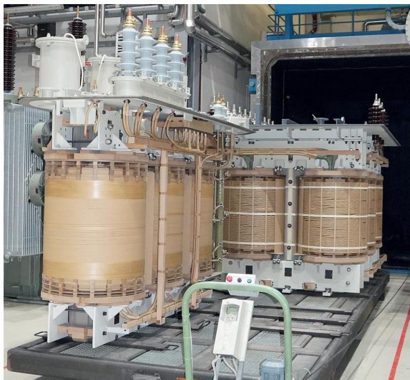
Slika 6. Celulozna izolacija omotana oko aktivnih dijelova [15]
