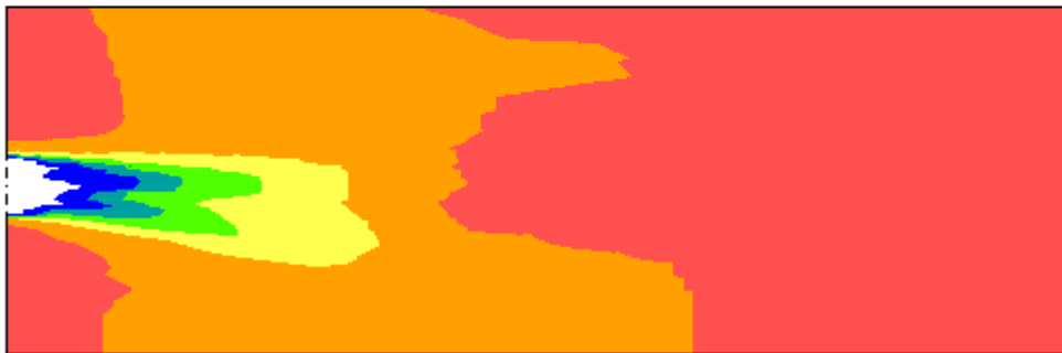
Slika 4.14. Mjerena distribucija ugljik (IV) oksida u horizontalnoj ravnini ložišta u visini gorionika
