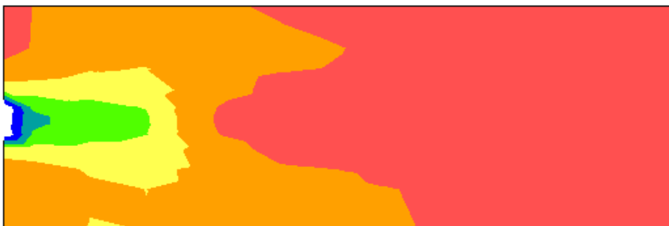
Slika 4.15. Izračunata distribucija ugljik (IV) oksida u horizontalnoj ravnini ložišta u visini gorionika
