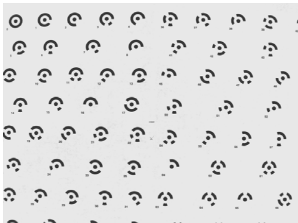
Slika 9.1. Detalj planarnog kalibracijskog objekta
