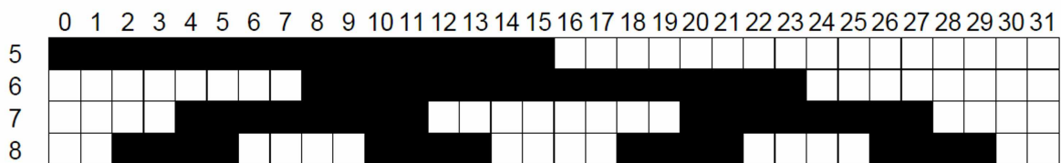
Slika 2.11. Princip metode Gray koda
