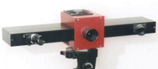
Slika 2.1. Projekcijski digitalizacijski sustav "Atos"
