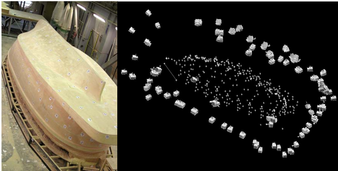
Slika 8.21. a) detalj pripremljene površine brodice, b) oblak kalibracijskih točaka s ilustracijom položaja kamere
