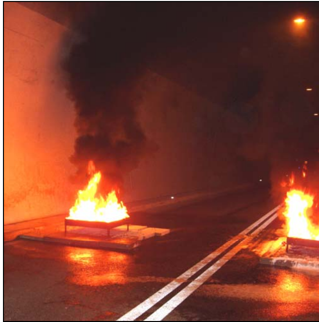
Foto 6: Generiranje dima neposredno nakon zapaljenja gorive smjese, u_z = 0 \div 0,5 m/s (uočljiv je uzgon dima, bez otklona u odnosu na vertikalnu os!)
