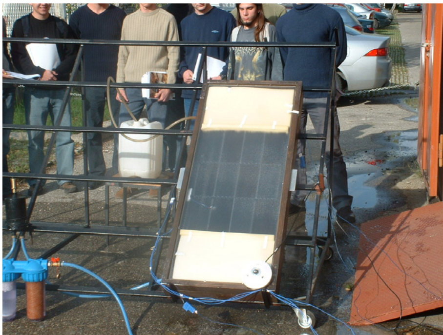
Slika 3.9 Fotografija dijela mjerne linije pri mjerenju zasjenjenog prototipa
