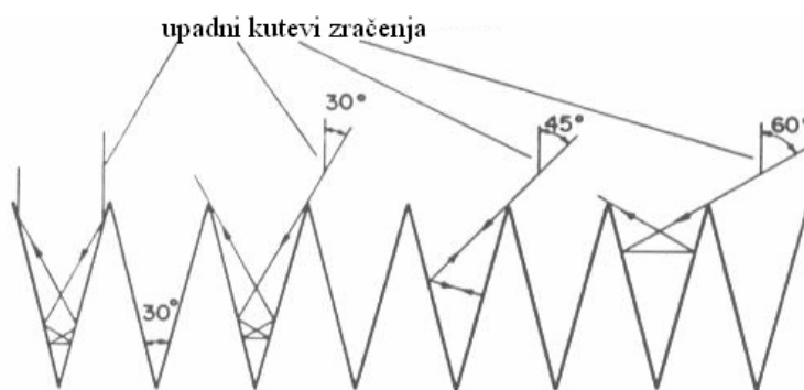
Slika 2.21 Apsorpcija odbijenog zračenja od stijenki V-utora, kut otvora žlijebova 30°, [26]
