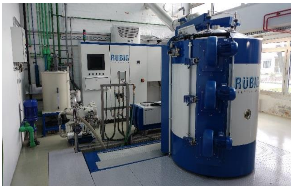
Slika 18 Vakuumska peć PC 70/90 S za nitriranje u plazmi i PACVD prevlačenje
