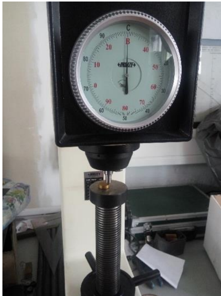
Slika 21 Ispitivanje adhezivnosti prevlake TiN na Rockwell-ovom tvrdomjeru
