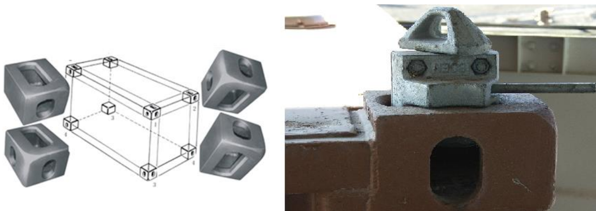
Slika 3. Čelični okvir i kutni okovi (lijevo) i “twistlock“ sistem (desno) [8], [9]
