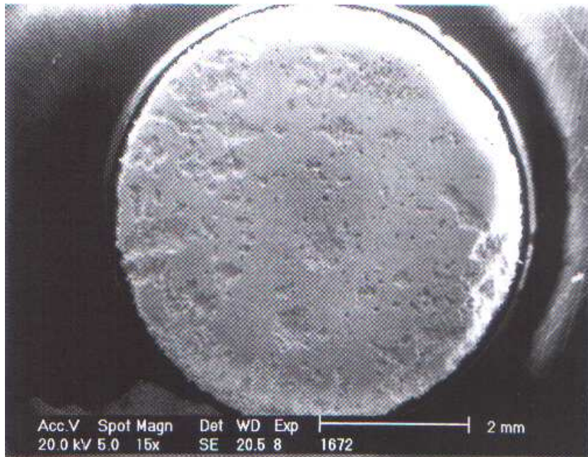
Slika 79. Dugo polimerizirana površina elektrode (15x)
