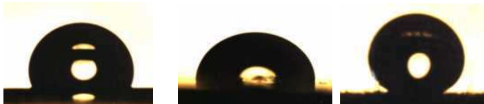
a) Voda na netretiranoj FEP foliji ( 110^\circ )
